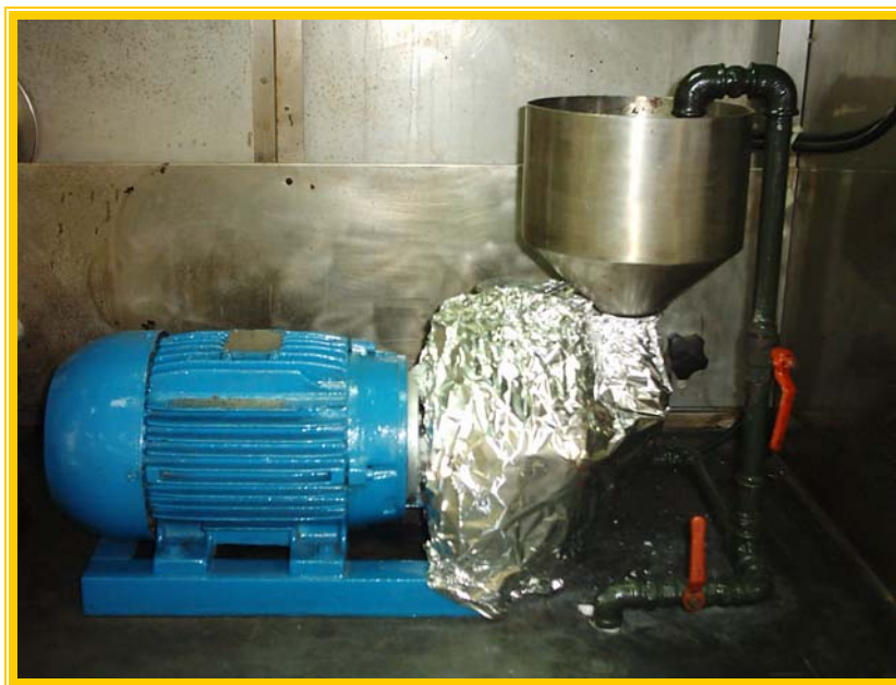
Figura 30. Molino Coloidal utilizado para realizar la emulsión asfáltica de forma instantánea.
