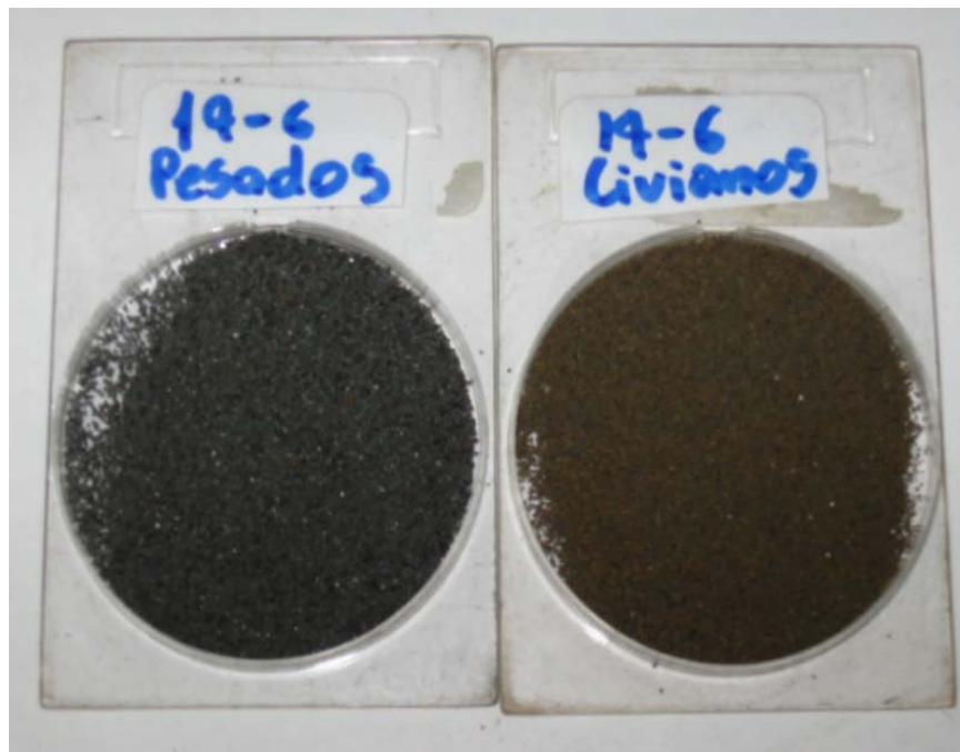
Figura 4: Minerales pesados y livianos separados por el hidrodinámico de una muestra de suelo.
