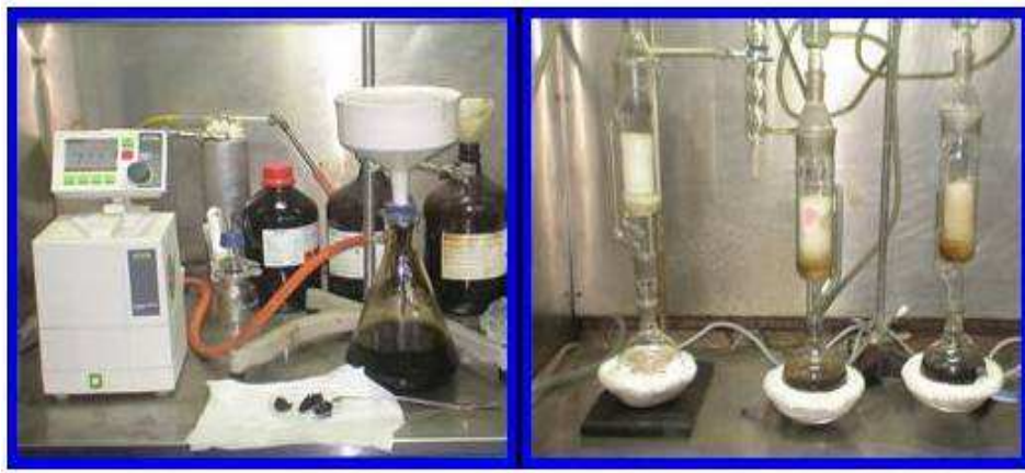
a) Filtración de los asfaltenos B) Sistema Soxhlet para el lavado Figura 18 Montaje experimental empleado para la desasfaltación.
