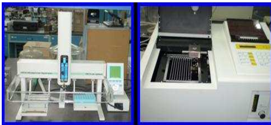
Figura 16. Equipos utilizados en la determinación SARA por TLC/FID. a) Autoaplicador SES-4250, b) Iatroscan MK6s
