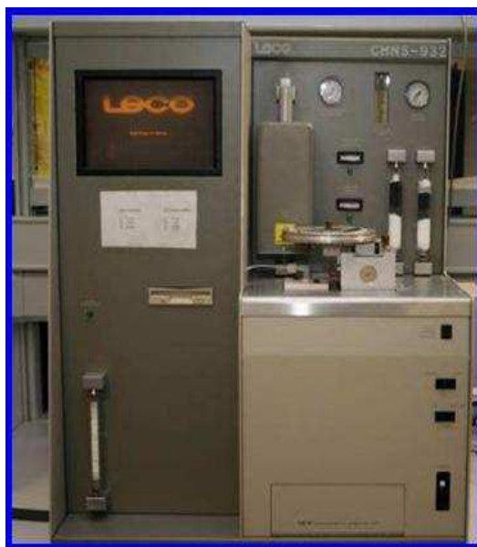
Figura 14. Analizador Elemental empleado en la determinación de carbono C e H
