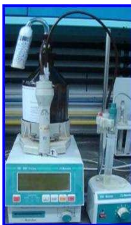
Figura 10. Titulador potenciométrico. Determinación de la acidez y nitrógeno básico
