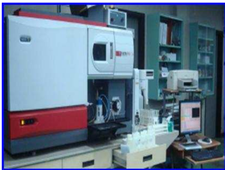
Figura 12. Equipo de ICP-OES. Marca Varían. Modelo Vista Pro, utilizado en la determinación del contenido de metales
