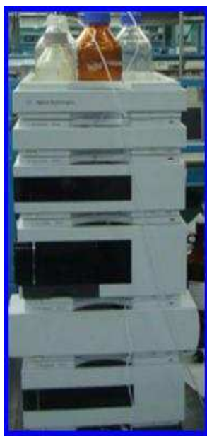
Figura 17. Equipo Agilent HPLC 1200 utilizado para CET
