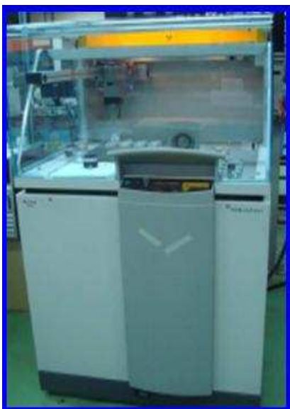
Figura 13. Equipo PAnalytical empelado en la fluorescencia de rayos X.
