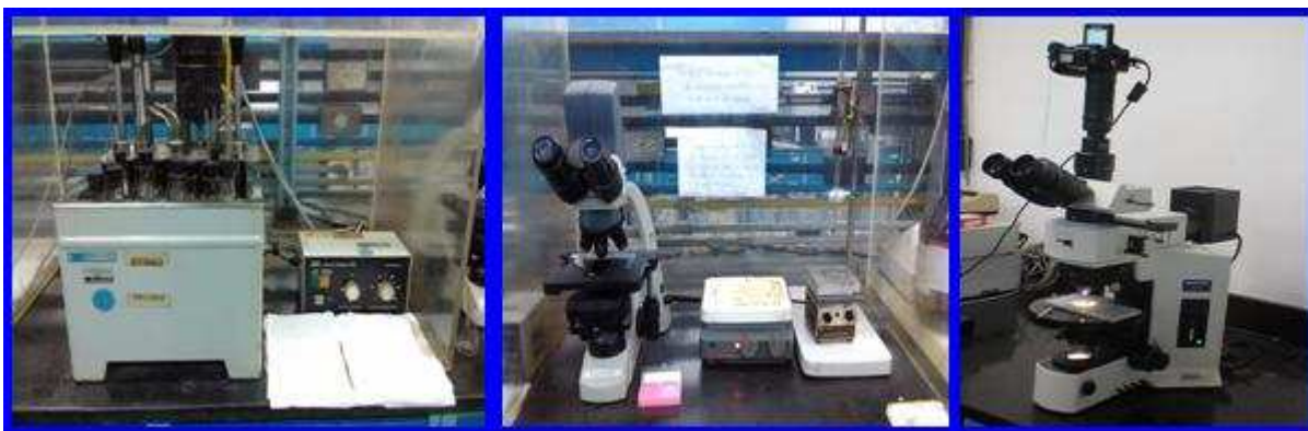
Figura 8. Montaje para la determinación de Valor P y la toma de fotografías a escala del microscopio.
