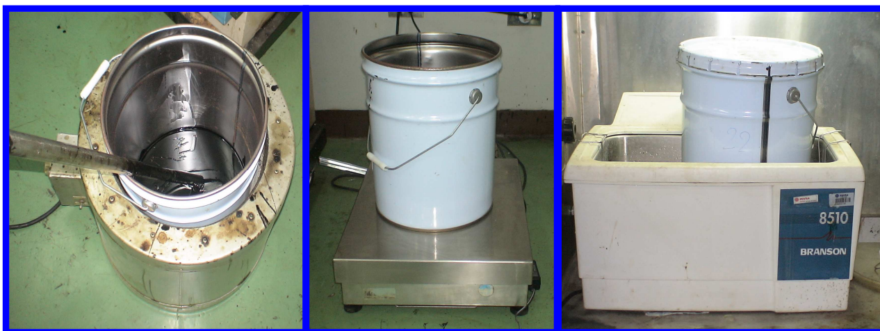
Figura 6 Montaje experimental para la preparación de la mezclas DCOM
