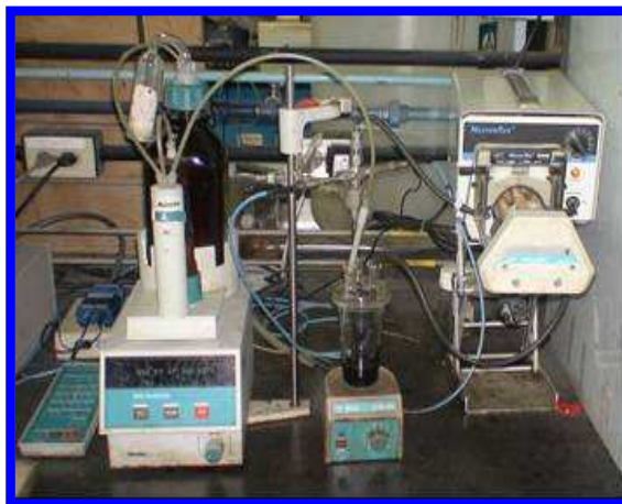
Figura 9. Montaje experimental utilizado para la determinación del Índice P de Heithaus.
