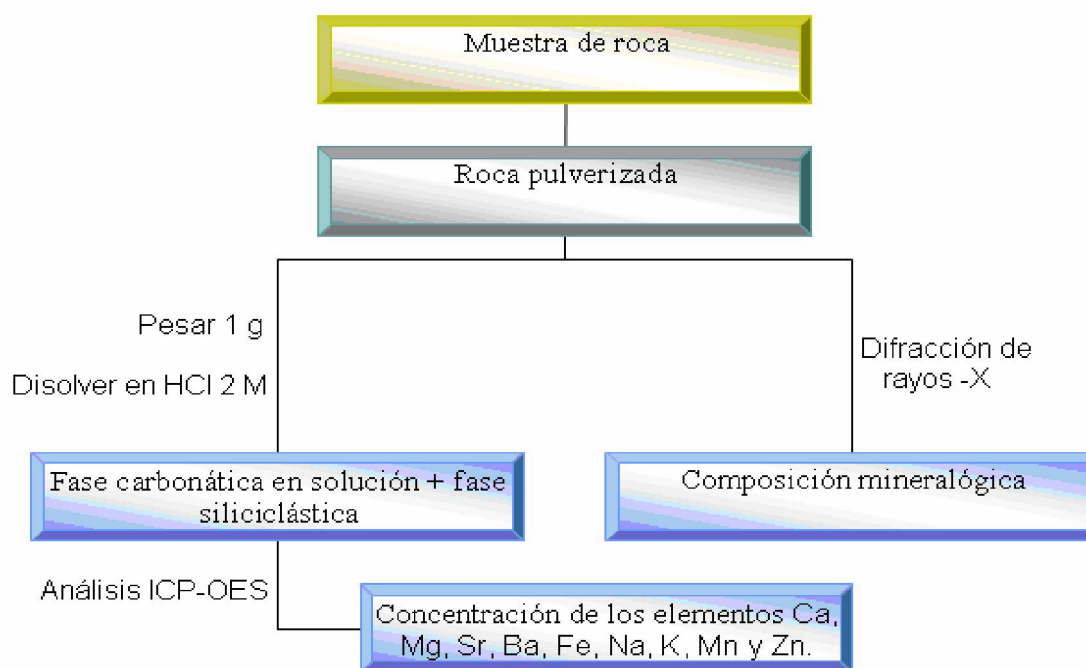
Figura 13. Esquema experimental para el análisis elemental y mineralógico de las muestras.
