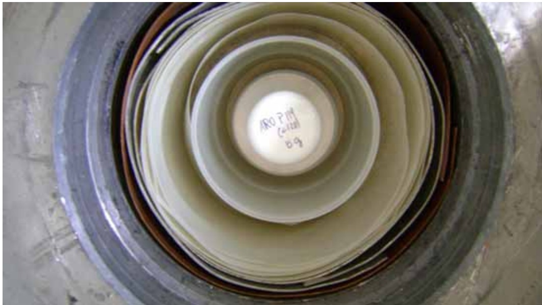
Figura 2. Interior del blindaje de plomo para disminuir el nivel fondo de radiactividad ambiental y carcasa de aluminio del detector HPGe.
