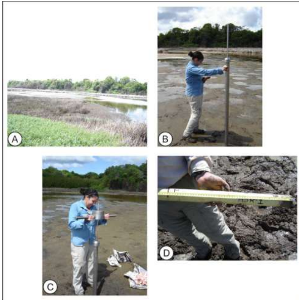
Figura 20. Etapa de Campo, extracción del núcleo HSR-1. A: Planicie Lagunar. B: Ubicación de las coordenadas del punto de muestreo. C: Proceso de extracción del núcleo. D: Longitud del núcleo recuperado.
