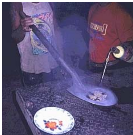
FIGURA 6. Calentamiento de la amalgama mercurio-oro 10
