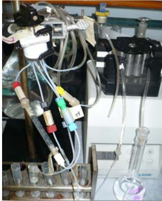
FIGURA 24. Montaje para el proceso de adsorción-desorción.
