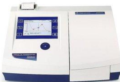
Figura 17. Equipo utilizado para el análisis de las dispersiones acuosas y para las muestras tomadas en las reacciones fotocatalíticas para la degradación de moléculas orgánicas.
