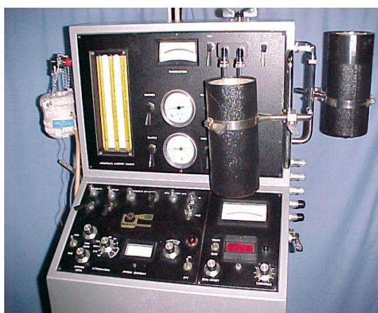
Figura 15. Equipo utilizado para la determinación de área específica de los sólidos sintetizados.
