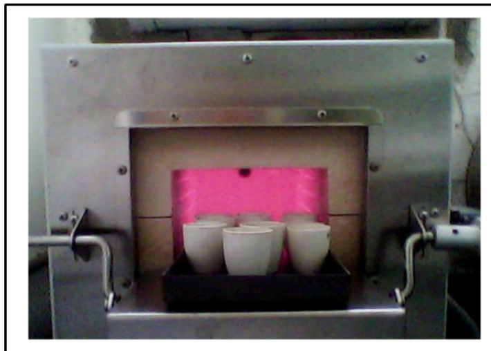
Fig. 8. Muestras de suelo en mufla digital a 750 °C. Foto Maria Marrero.
