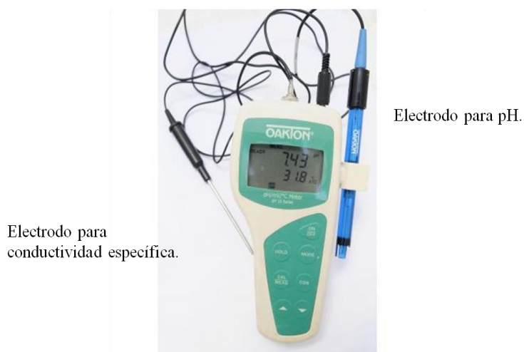
Fig. 6. pHmetro empleado para la medición de pH y conductividad específica en las muestras de suelo.
