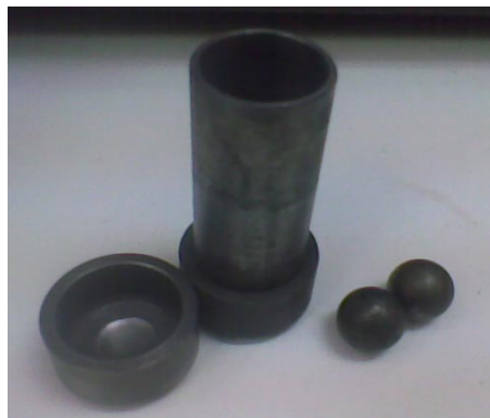
Figura 3.8: SPEX 8000 mill, vial con las bolas esferas
