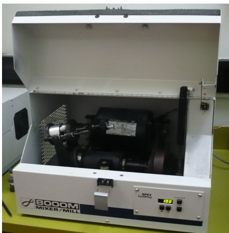
Figura 3.6: SPEX 8000 mill con cubierta abierta
