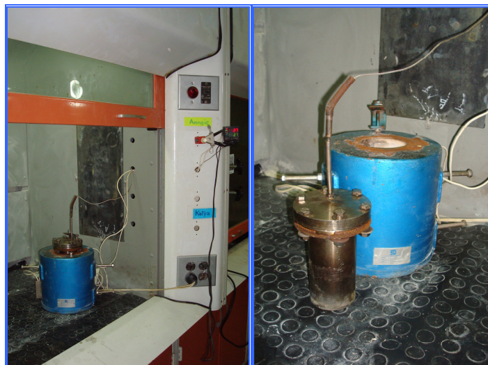
Figura 20. Reactor de acero empleado para las experiencias de despolimerización bajo condiciones de presión elevada
