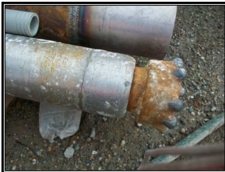
Figura 22. Utensile di perforazione
