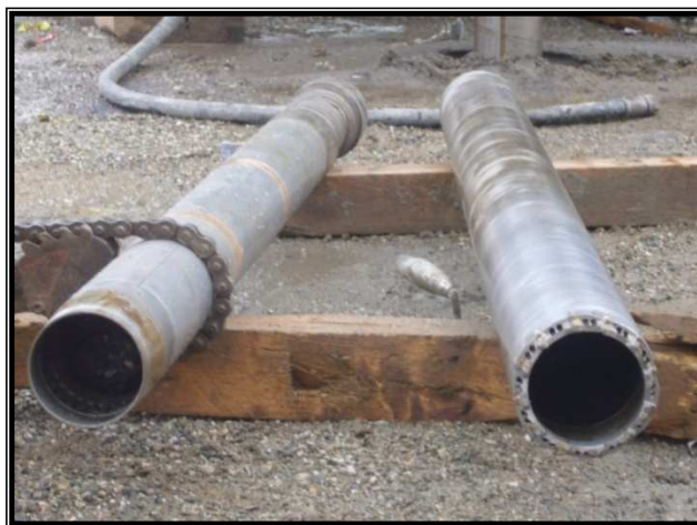
Figura 30. Carotiere interno ed esterno
