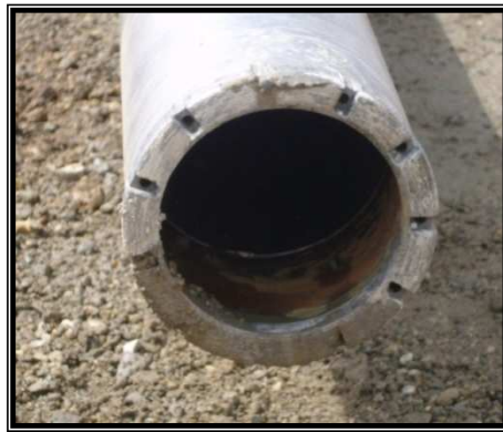
Figura 29. Corona tagliente del carotiere F6S
