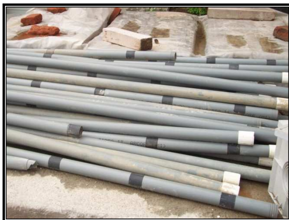
Figura 24. Canne Manchette con interasse di 0,5m.
