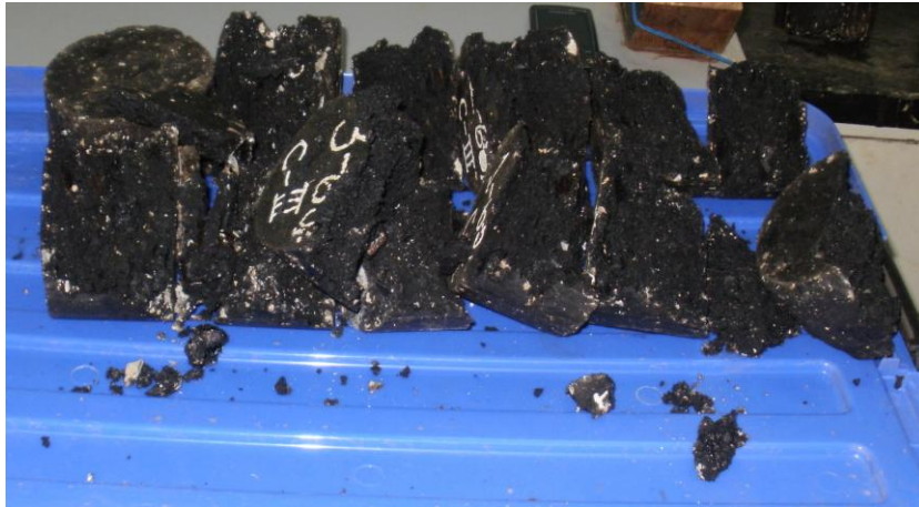
Anexo 65. Ensayo Marshall. Briquetas después del ensayo.
