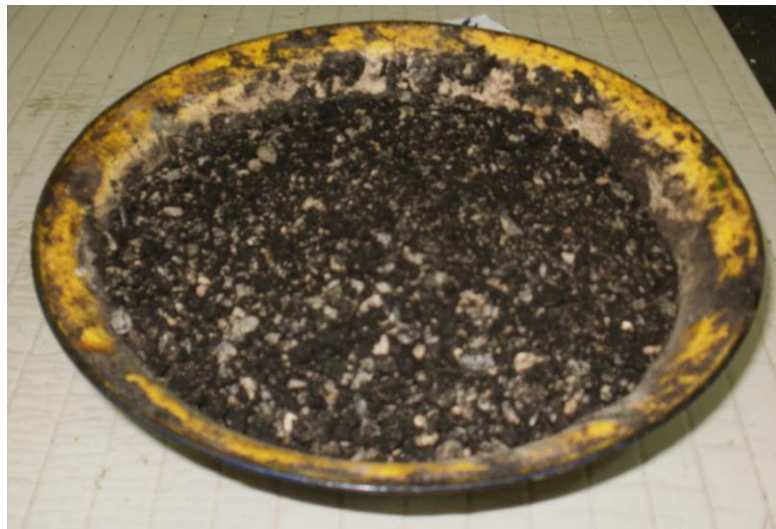
Anexo 66. Ensayo Rice. Muestra a ensayar fracción fina.
