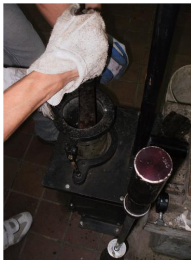
Anexo 48. Ensayo Marshall. Preparación de la mezcla.
