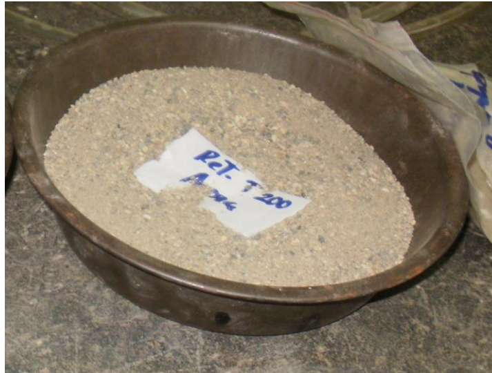
Anexo 27. Peso específico de Agregados Finos. Muestra a ensayar.
