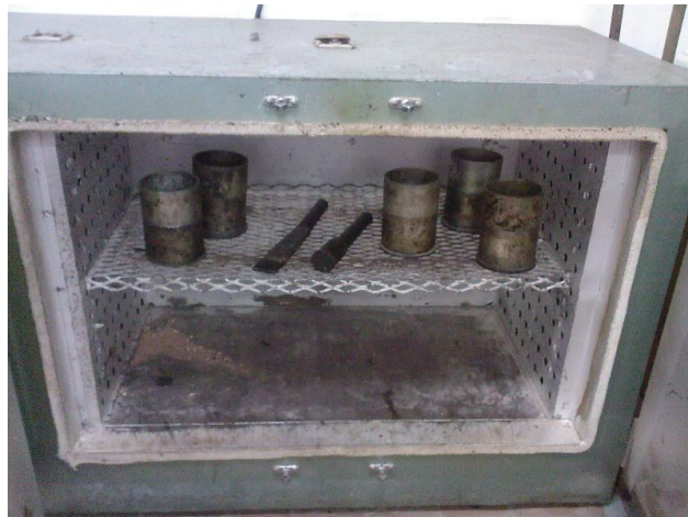
Anexo 44. Ensayo Marshall. Calentamiento de los moldes.
