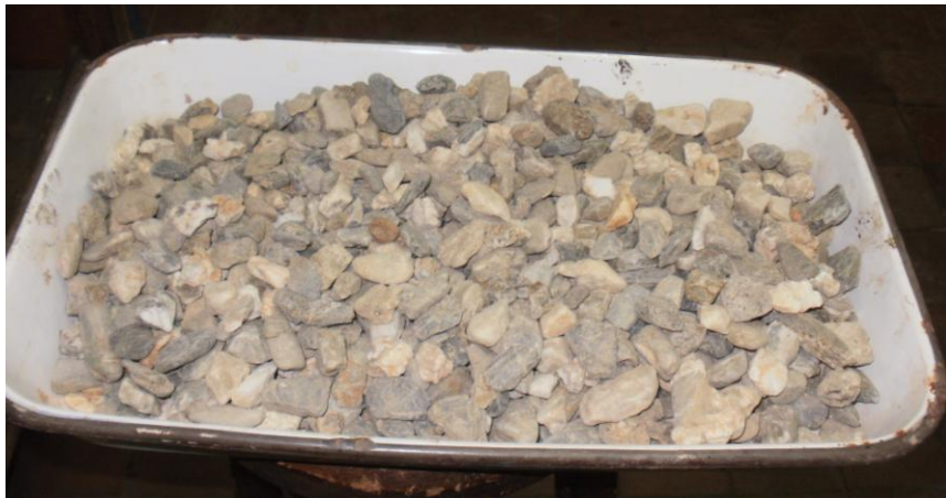
Anexo 16. Ensayo % Caras Largas y Aplanadas. Muestra a ensayar.
