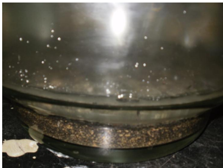
Anexo 73. Ensayo Rice. Extracción de vacíos.
