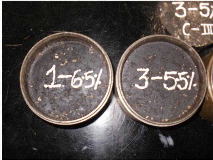
Anexo 51. Ensayo Marshall. Enfriamiento de las briquetas.
