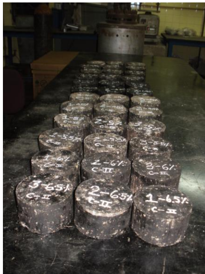
Anexo 54. Ensayo Marshall. Briquetas.
