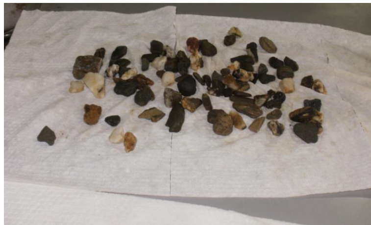
Anexo 24. Peso específico de Agregados Gruesos. Secado de la muestra.
