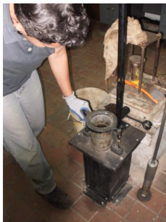
Anexo 46. Ensayo Marshall. Ajuste de los moldes.
