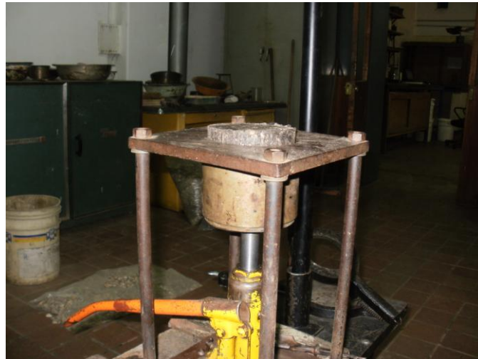
Anexo 52. Ensayo Marshall. Extracción de las briquetas.
