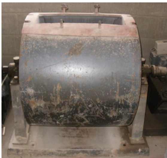
Anexo 11. Ensayo Desgaste Los Ángeles. Máquina de desgaste Los Ángeles.
