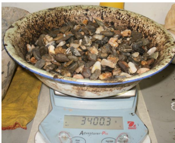
Anexo 25. Peso específico de Agregados Gruesos. Pesado de la muestra húmeda.
