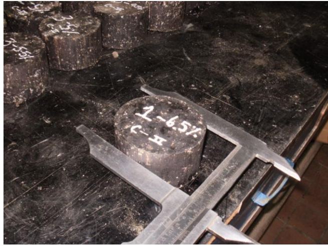
Anexo 55. Ensayo Marshall. Medición de las briquetas.
