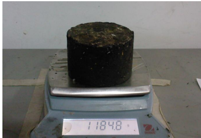
Anexo 60. Ensayo Marshall. Pesaje de las briquetas después del secado.
