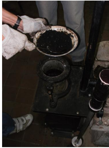
Anexo 47. Ensayo Marshall. Colocación de la mezcla.
