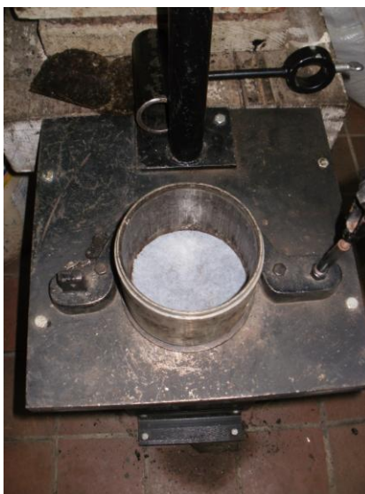
Anexo 45. Ensayo Marshall. Preparación de los moldes.
