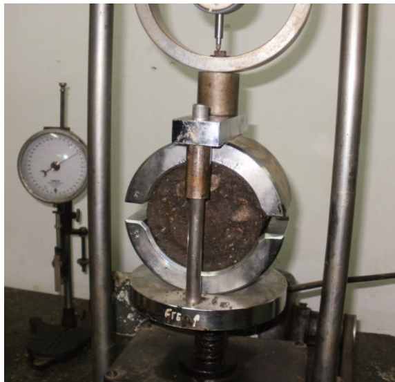
Anexo 62. Ensayo Marshall. Colocación de la briqueta en la prensa.
