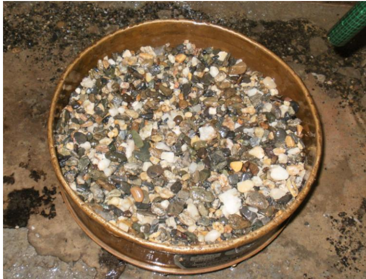
Anexo 21. Peso específico de Agregados Gruesos. Muestra lavada.
