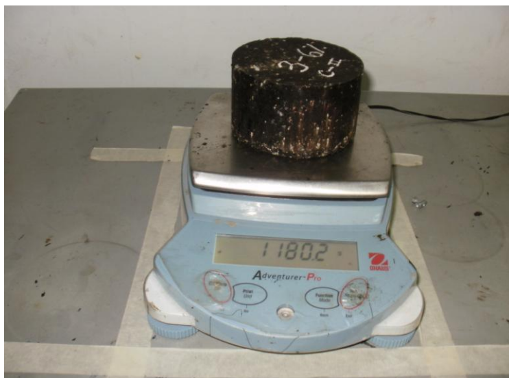
Anexo 57. Ensayo Marshall. Pesaje de las briquetas.
