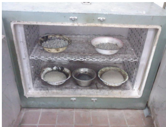
Anexo 40. Ensayo Marshall. Agregados en el horno.
