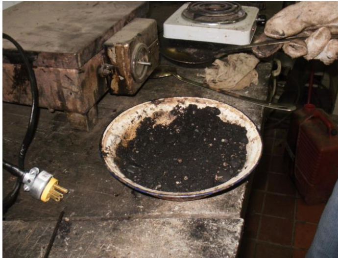
Anexo 43. Ensayo Marshall. Mezclado.
