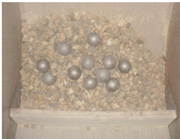
Anexo 12. Ensayo Desgaste Los Ángeles. Muestra preparada para la trituración.
