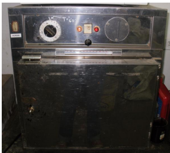
Anexo 38. Ensayo Marshall. Horno para calentar el cemento asfáltico.
