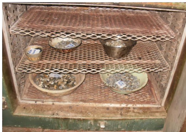
Anexo 26. Peso específico de Agregados Gruesos. Secado de agregados en el horno.
