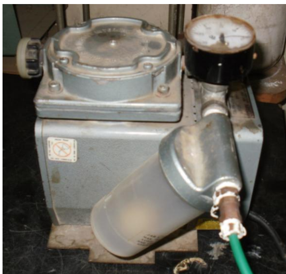
Anexo 71. Ensayo Rice. Bomba de extracción de vacíos.
