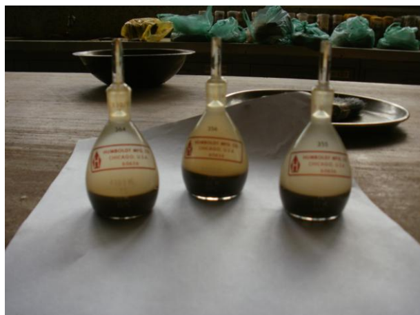
Anexo 37. Peso específico de Agregados pasa 200. Muestra después de la extracción.
