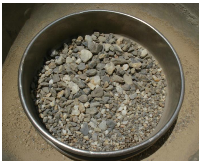
Anexo 14. Ensayo Desgaste Los Ángeles. Muestra retenida en el tamiz N° 12.
