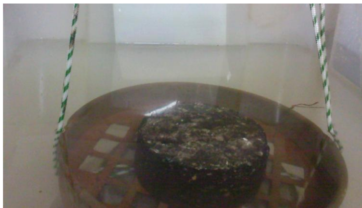
Anexo 58. Ensayo Marshall. Pesaje en el agua.
