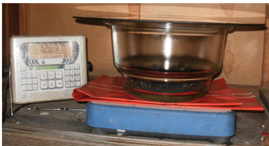
Anexo 70. Ensayo Rice. Pesaje de frasco + muestra + lámina de vidrio.
