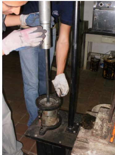
Anexo 50. Ensayo Marshall. Compactación de la mezcla.
