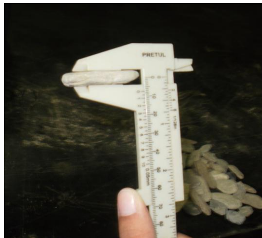
Anexo 18. Ensayo % Caras Largas y Aplanadas. Medición del espesor de las partículas.
