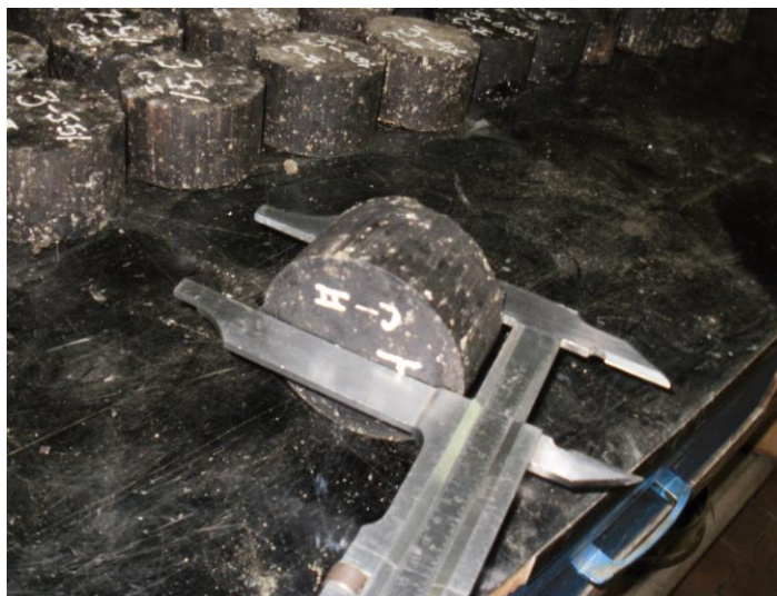
Anexo 56. Ensayo Marshall. Medición de las briquetas.
