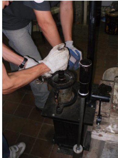
Anexo 49. Ensayo Marshall. Preparación de la mezcla.
