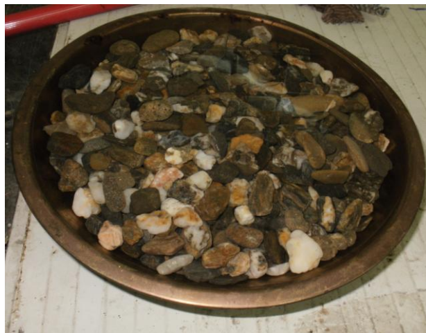
Anexo 22. Peso específico de Agregados Gruesos. Muestra en remojo.
