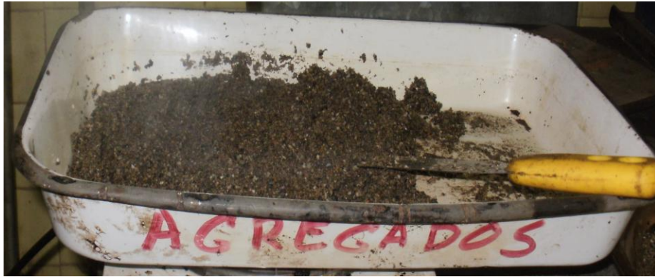
Anexo 29. Peso específico de Agregados Finos. Secado de la muestra.
