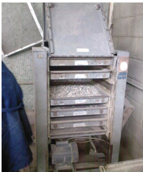
Anexo 9. Ensayo Desgaste Los Ángeles. Máquina de tamices.
