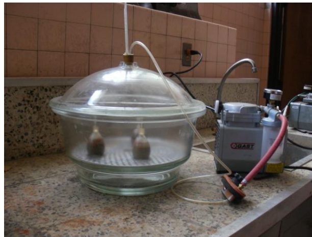
Anexo 36. Peso específico de Agregados pasa 200. Extracción de vacíos.
