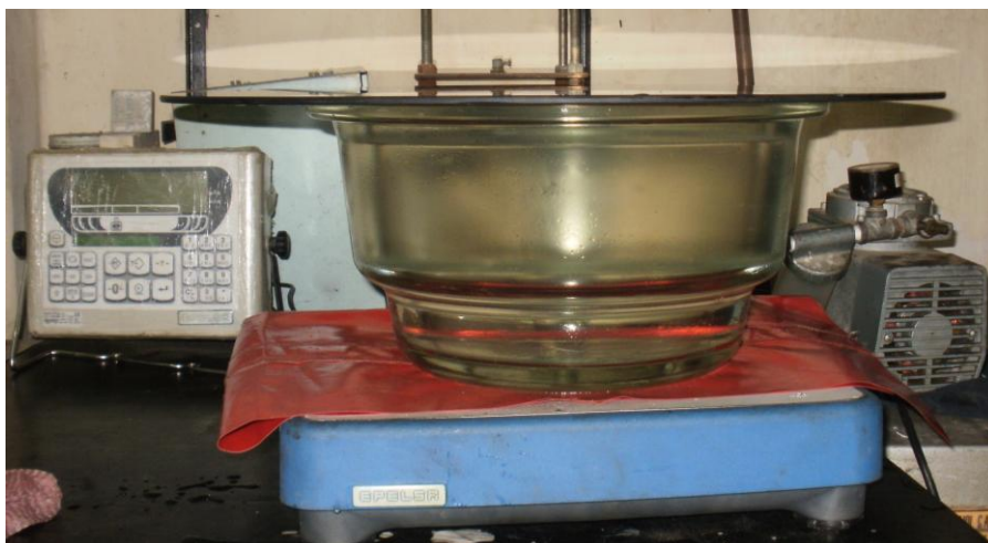
Anexo 69. Ensayo Rice. Pesaje de frasco + agua + lámina de vidrio.
