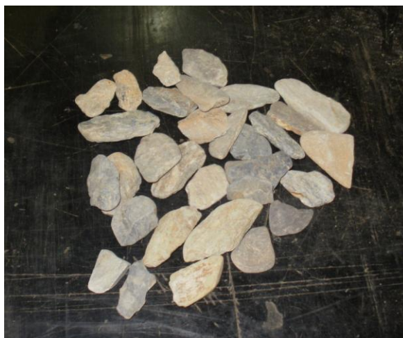
Anexo 19. Ensayo % Caras Largas y Aplanadas. % de partículas de caras largas y aplanadas.
