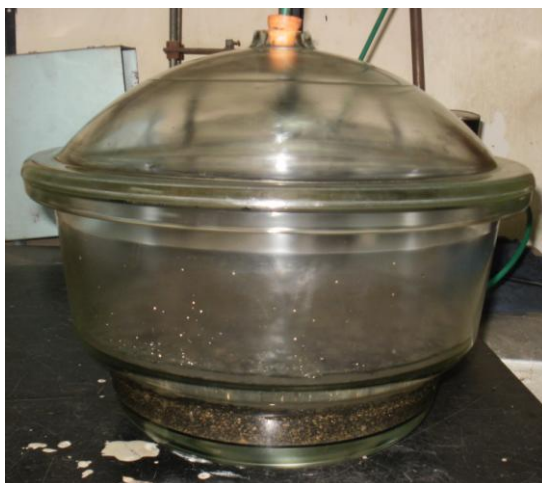
Anexo 72. Ensayo Rice. Extracción de vacíos.
