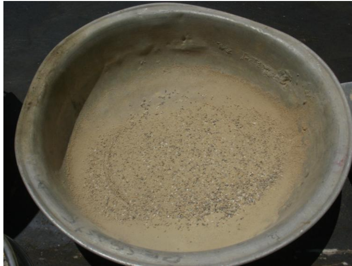
Anexo 15. Ensayo Desgaste Los Ángeles. Muestra sobrante.
