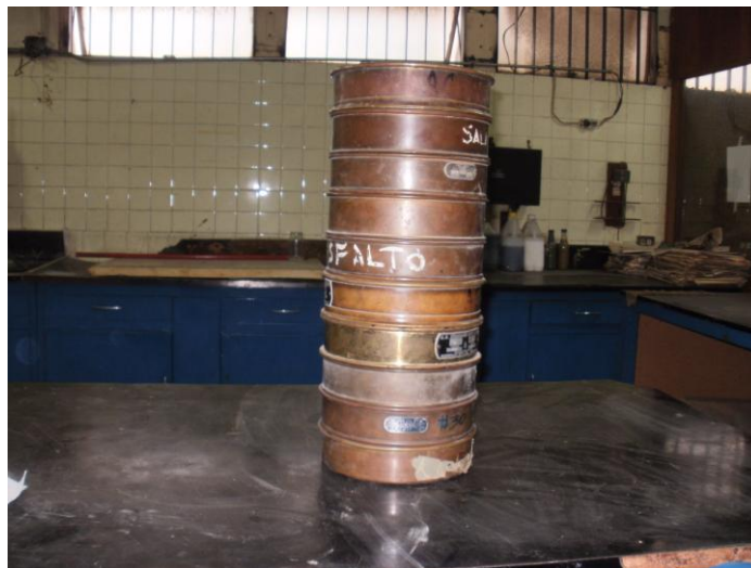
Anexo 8. Composición granulométrica. Tamices.
