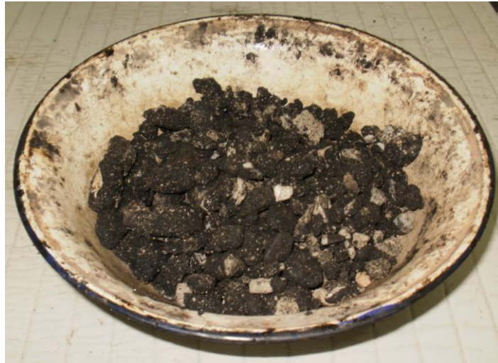
Anexo 67. Ensayo Rice. Muestra a ensayar fracción gruesa.
