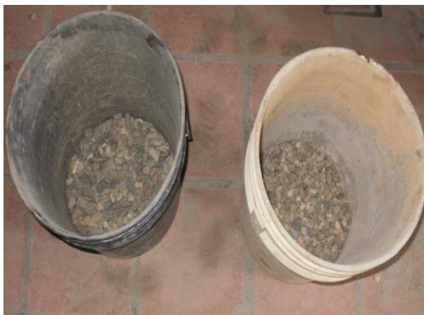
Anexo 10. Ensayo Desgaste Los Ángeles. Muestra a ensayar.
