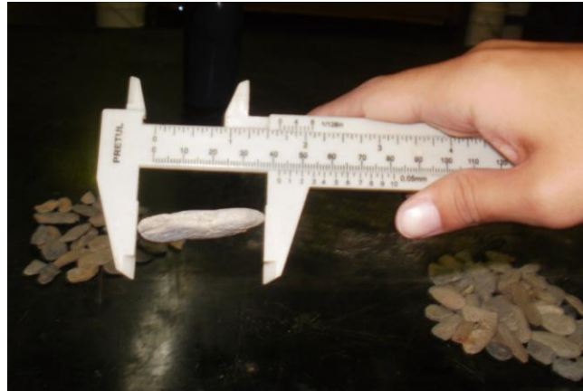
Anexo 17. Ensayo % Caras Largas y Aplanadas. Medición del largo de las partículas.
