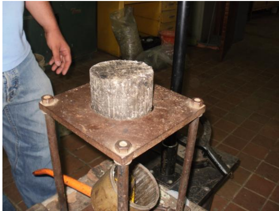
Anexo 53. Ensayo Marshall. Extracción de las briquetas.
