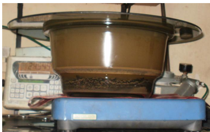
Anexo 74. Ensayo Rice. Pesaje de frasco + muestra + agua +lámina de vidrio después de la extracción de vacíos.
