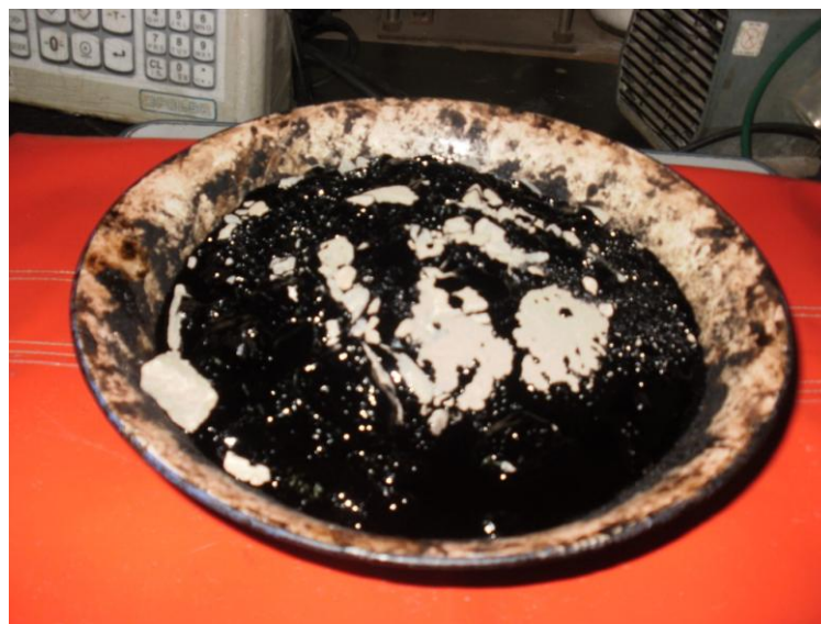
Anexo 42. Ensayo Marshall. Pesaje de Cemento Asfáltico.
