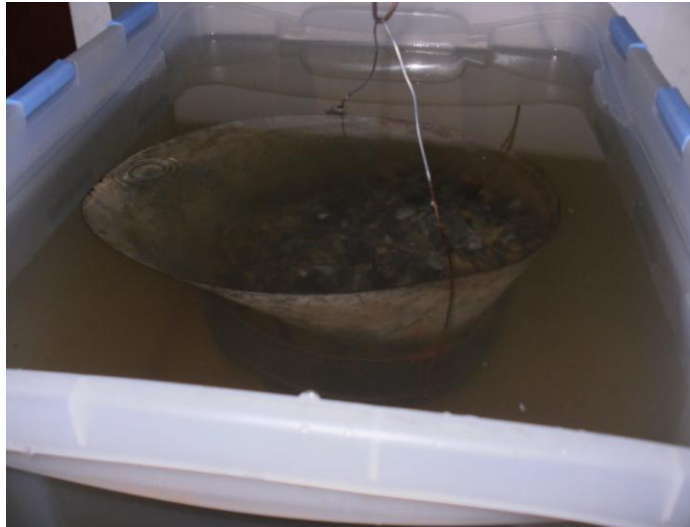
Anexo 23. Peso específico de Agregados Gruesos. Peso en el agua.
