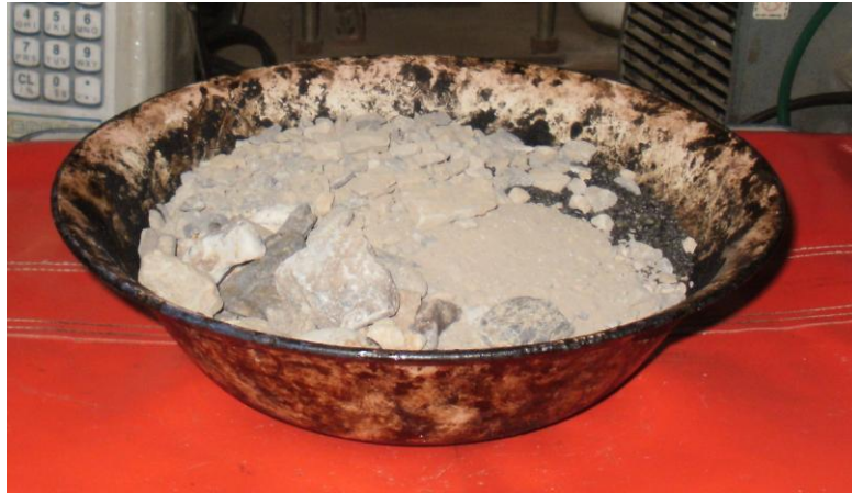
Anexo 41. Ensayo Marshall. Pesaje de agregados.
