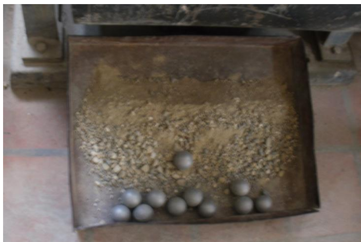
Anexo 13. Ensayo Desgaste Los Ángeles. Muestra triturada.
