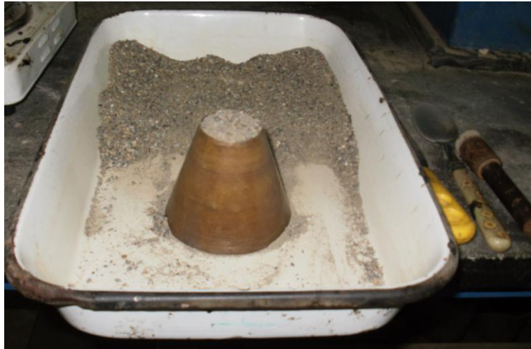
Anexo 31. Peso específico de Agregados Finos. Ensayo del cono.
