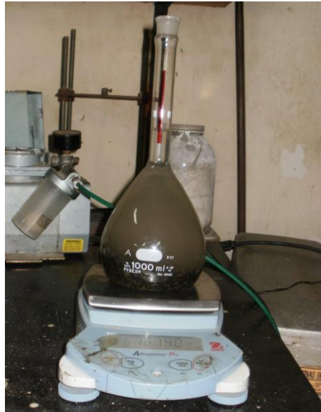
Anexo 33. Peso específico de Agregados Finos. Pesaje de la muestra.
