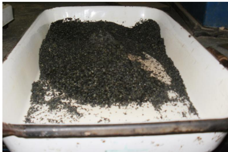
Anexo 32. Peso específico de Agregados Finos. Resultado del ensayo del cono.
