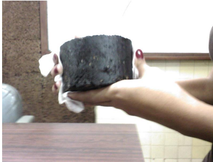
Anexo 59. Ensayo Marshall. Secado de las briquetas.
