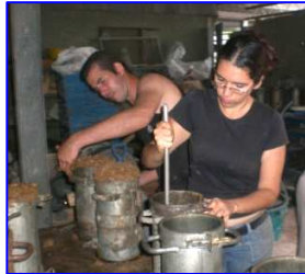
Foto III.23 Compactación de la Mezcla
