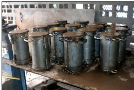
Foto III.24 y III.25 Mezcla vaciada en los moldes y enrasadas
