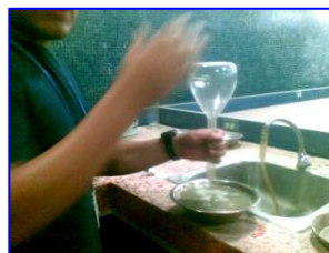
Foto III.5 Inmersión del Agregado fino
