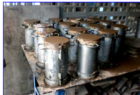
Foto III.24 y III.25 Mezcla vaciada en los moldes y enrasadas
