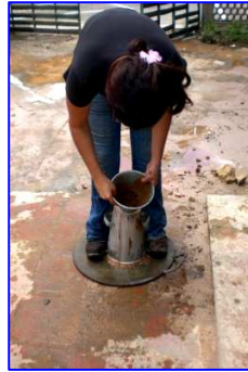
Foto III.16 Llenado del Cono de Abrams
