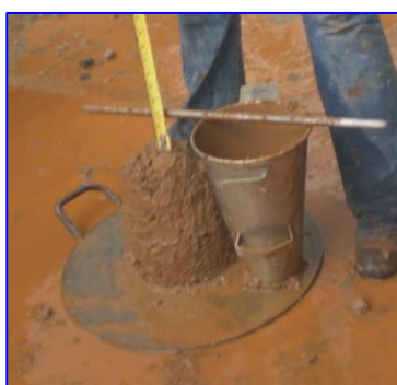
IV.2-a.- Asentamiento de mezcla con sustitución de 30%
