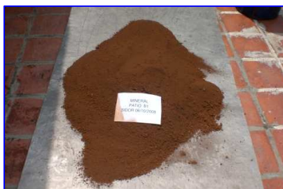
Foto III.2 Disposición del Mineral para realizar Método de cuarteo
