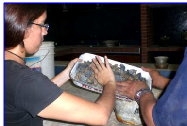
Foto III.10 Extracción del Agua al Agregado Grueso
