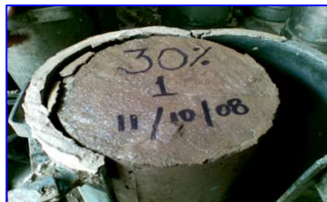
Foto III.25 y III.26 Desencofrado de las Probetas
