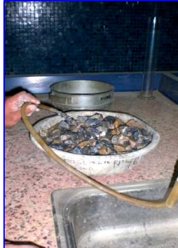
Foto III.9 Inmersión del Agregado Grueso
