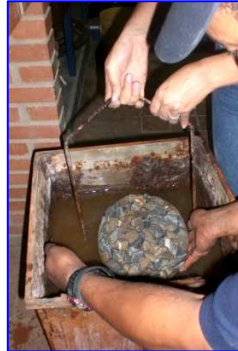
Foto III.11 Saturación de Poros del Agregado Grueso
