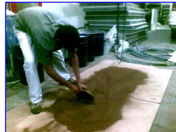
Foto III.1 y Foto III.2 Método de Cuarteo realizado al Mineral
