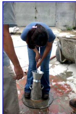
Foto III.17 Compactación de la Mezcla dentro del Cono
