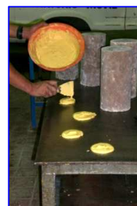
Foto III.32 y III.33 Colocación del Yeso sobre la mesa
