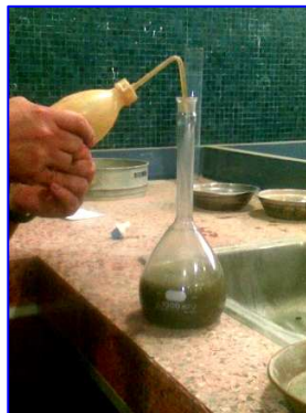
Foto III.6 Llenado del picnómetro
