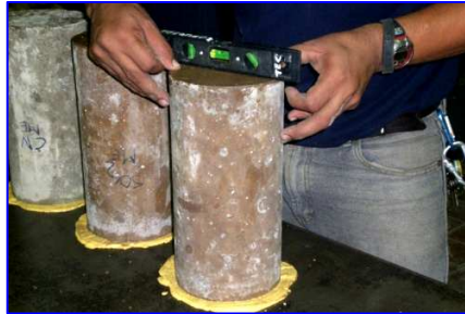
Foto III.34 Colocación de la probeta sobre el yeso y su nivelación
