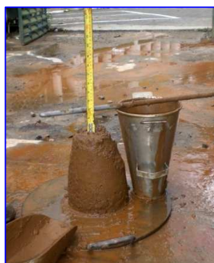
IV.2-c.- Asentamiento de mezcla con sustitución de 50%
