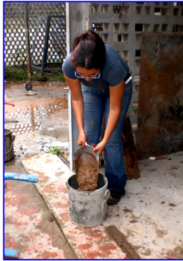
Foto III.20 Llenado del recipiente normado
