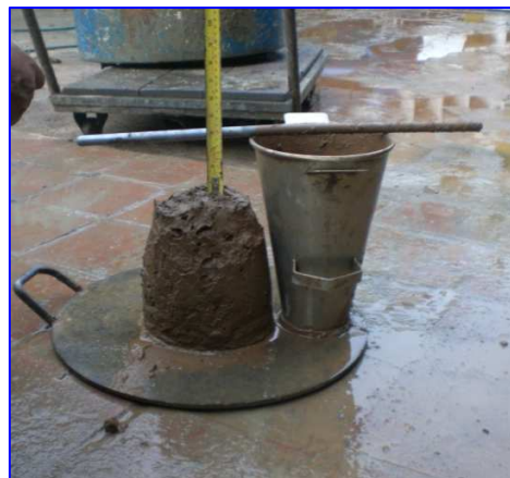
Foto IV.1 Medición del Asentamiento para Concreto Patrón con el Cono de Abrams
