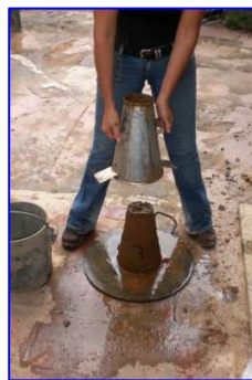
Foto IV.3 Asentamiento nulo, mezcla con 50% de sustitución de mineral
