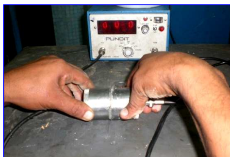
Foto III.28 Calibración del Instrumento
