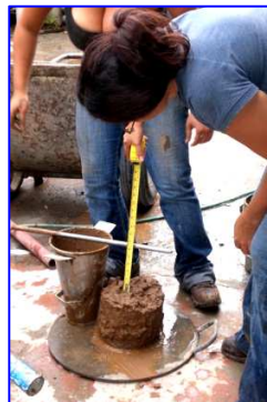
Foto III.19 Medición del Asentamiento
