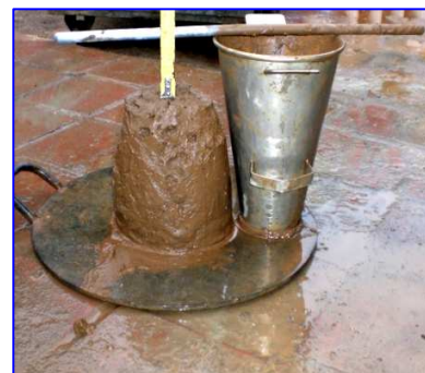
IV.2-b.- Asentamiento de mezcla con sustitución de 40%
