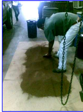
Foto III.1 y Foto III.2 Método de Cuarteo realizado al Mineral
