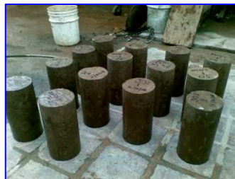
Foto III.27 Disposición de las Probetas ya Desencofradas
