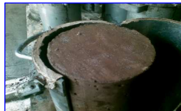
Foto III.25 y III.26 Desencofrado de las Probetas
