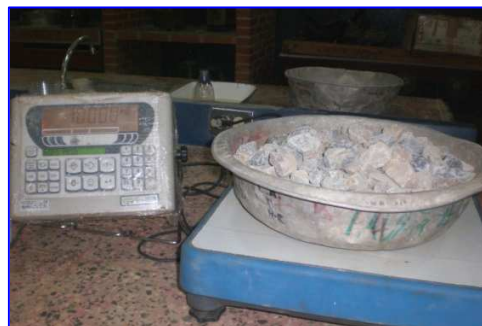
Foto III.8 Pesada del Agregado Grueso
