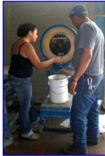
Fotos III.11.- Pesada de Agregado Grueso
