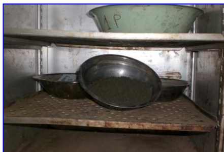
Foto III.4 Agregado Fino secado al Horno
