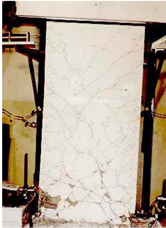
Figura 7: Falla de corte frágil en un muro
