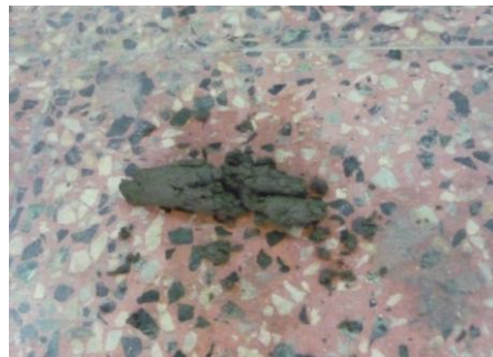
c-. Prueba del cordón y de la cinta
