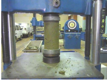
a-. Ensayo de la resistencia a la compresión
