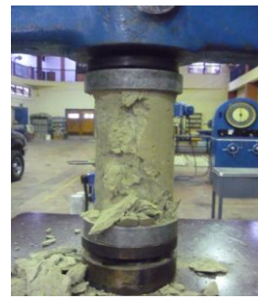
b-. Cilindro ensayado
