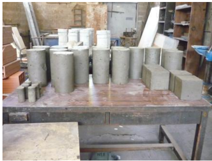
a-. Probetas desencofradas
