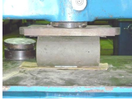
b-. Ensayo de tracción indirecta sobre probetas cilíndricas
