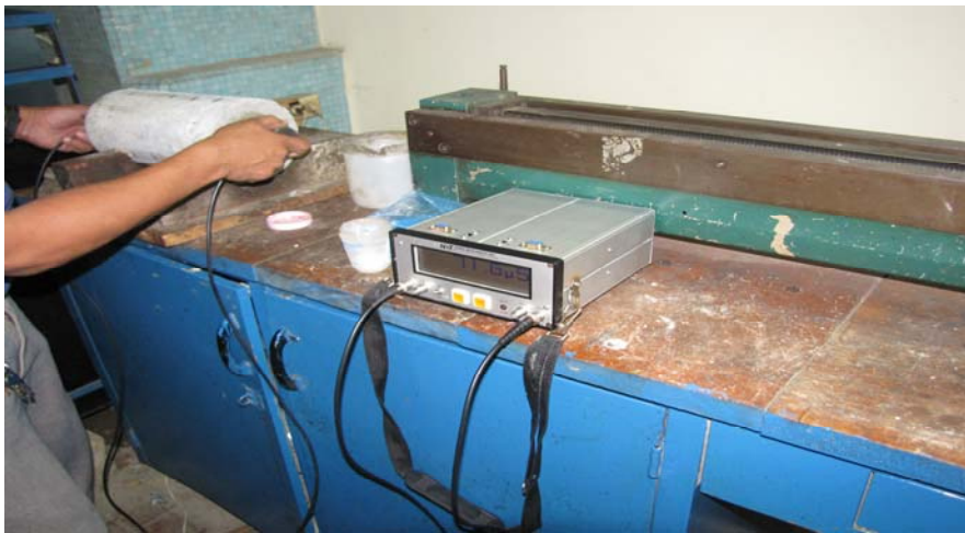
Foto # 20: Realización del ensayo de ultrasonido. Fuente: Elaboración propia.
