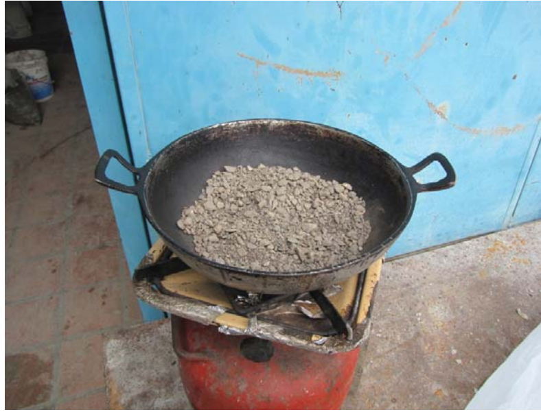
Foto # 15: Secado del agregado fino mediante el uso de un mechero, laboratorio de Agregados IMME. Fuente: Elaboración propia.
