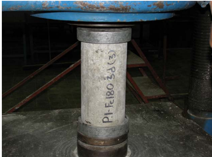
Foto # 23: Probeta de un ejemplar de mezcla Portland I de resistencia 180 \text{ Kg/cm}^2 a una edad de 3 días. Fuente: Elaboración propia.
