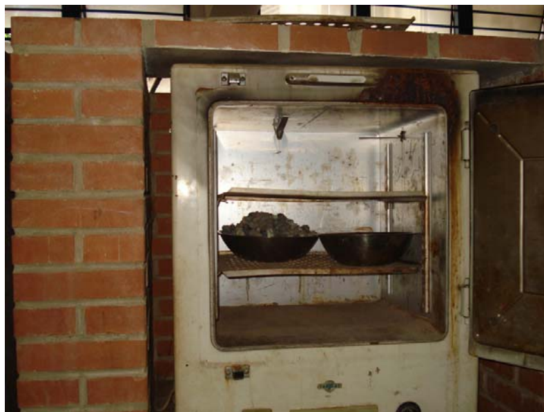
Foto # 14: Secado de los agregados fino mediante el uso de un horno, laboratorio de Suelos IMME. Fuente: Elaboración propia.
