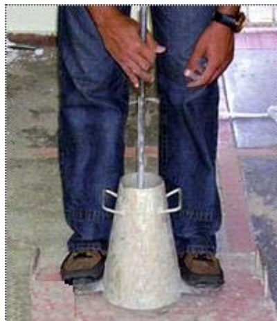
Foto # 3: Elaboración del ensayo del Cono de Abrams Vista Frontal, Fuente: Desconocida.
