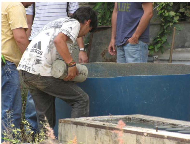
Foto # 19: Colocación de los cilindros en el tanque de curado, 24 horas después del vaciado. Fuente: Elaboración propia.
