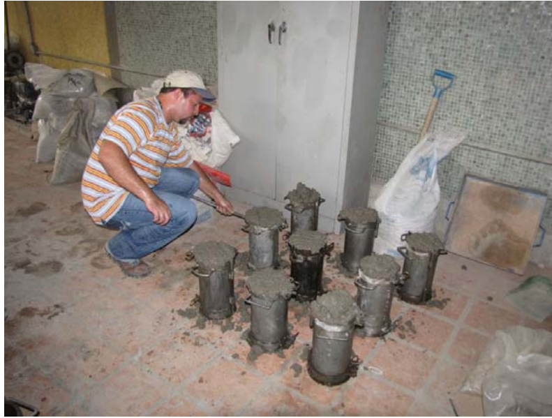
Foto # 16: Vaciado de los nueve moldes necesarios para cada tipo de concreto. Fuente: Elaboración propia.
