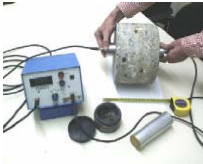
Foto # 5: Método de ultrasonido. Fuente: Norma Covenin 1976-2003.
