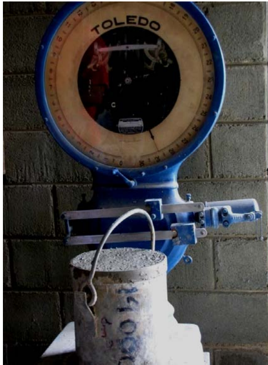
Foto # 18: Peso de una muestra de concreto para la determinación del Peso Unitario. Fuente: Elaboración propia.
