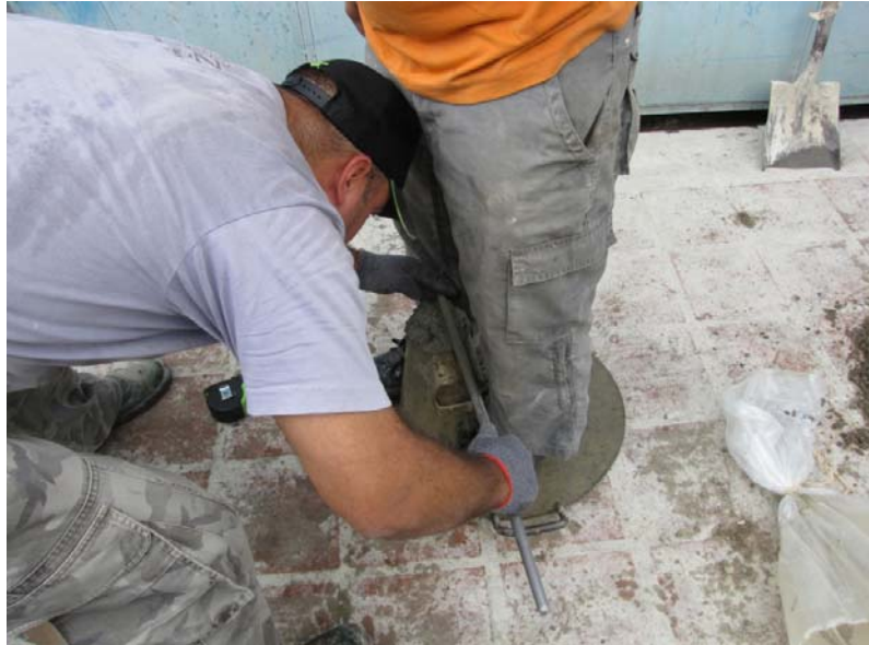
Foto # 17: Elaboración de ensayo de asentamiento según Norma COVENIN 0339:2003. Fuente: Elaboración propia.
