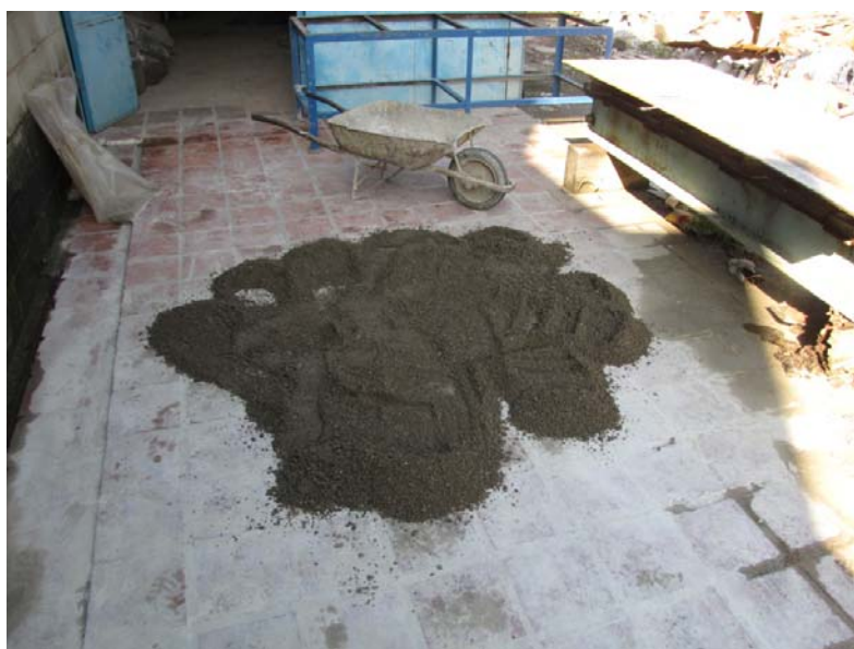
Foto # 13: Agregado mezclado y homogenizado, laboratorio de agregados del IMME. Fuente: Elaboración propia.
