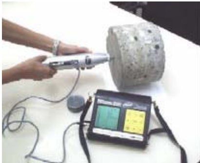
Foto # 7: Ensayo Esclerómetro. Fuente: Norma Covenin 1976-2003.
