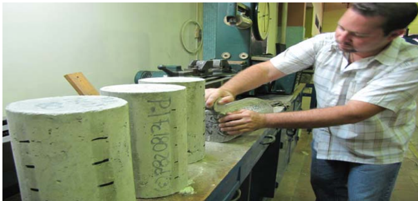
Foto # 21: Limpieza de la cara de los cilindros para la realización del ensayo de esclerometría. Fuente: Elaboración propia.
