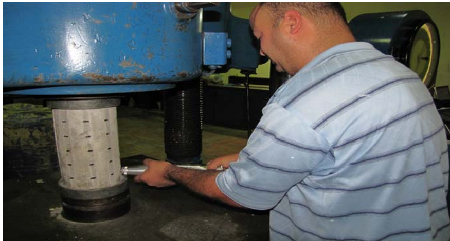
Foto # 22: Realización del ensayo de esclerometría. Fuente: Elaboración propia.
