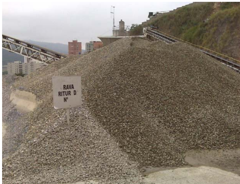
Foto # 8: Grava natural, almacenada en los patios de Lafarge La Bandera, nótese que en el aviso dice grava triturada, pero en realidad es grava natural. Fuente: Elaboración propia.
