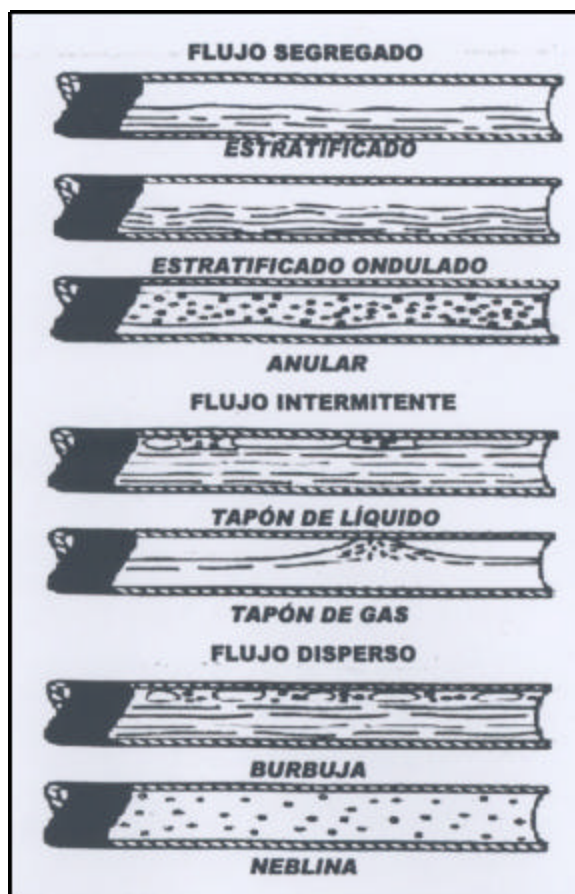
FIGURA 1.3. ESQUEMA DE REGÍMENES DE FLUJO HORIZONTAL
