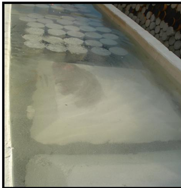
Foto 4: Piscina para el curado de las Bandejas de Concreto y los Cilindros Estandarizados
