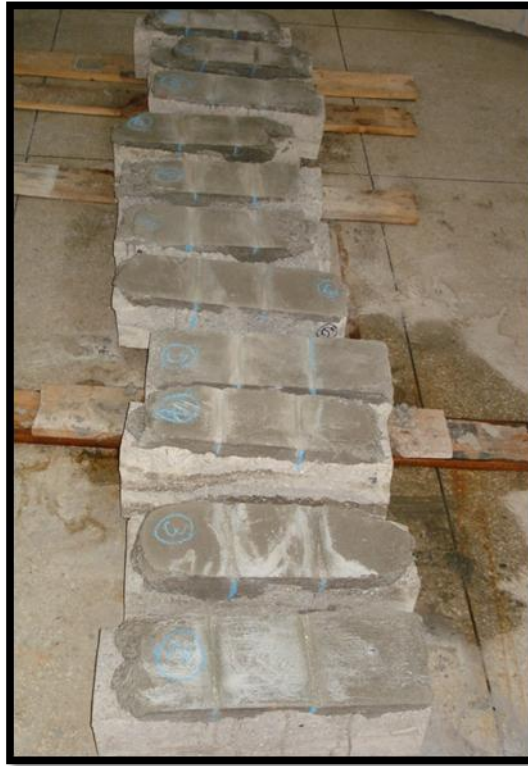
Foto 5: Viguetas Dramix Fuente: Elaboración Propia
