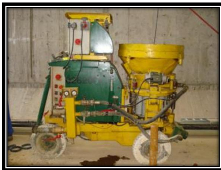
Foto 2.1. Equipo de Proyección por Vía Seca
