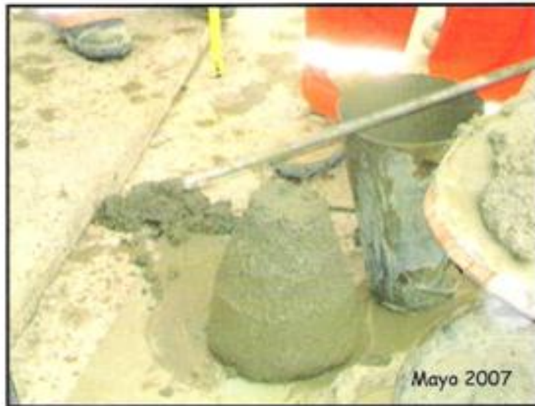
Foto 3: Prueba de Asentamiento del Cono de Abrams
