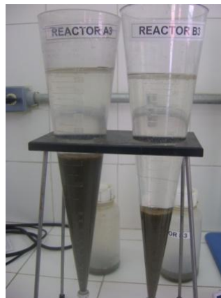
Figura 3.2. Medición de Sólidos Sedimentables en los reactores A y B
