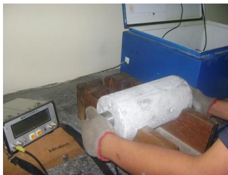
Figura 3.8. Ensayo de ultrasonido en las probetas a los 28 días.
