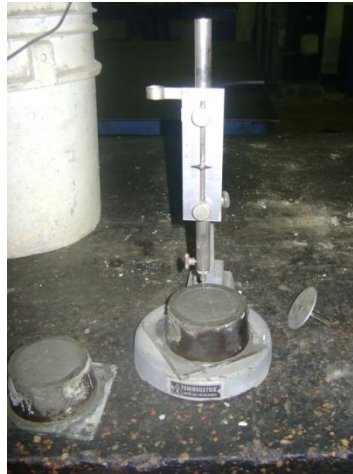
Figura 3.10. Medición del tiempo de fraguado por medio del Aparato de Vicat.
