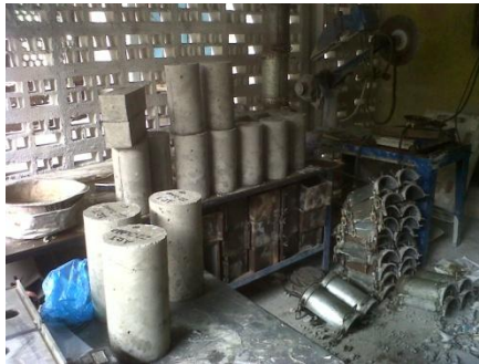
e.- Probetas desencofradas.
