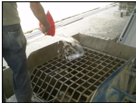
Imagen 7: Incorporación de agua a la mezcla
