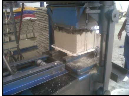
Imagen 10: Desmolde de los bloques
