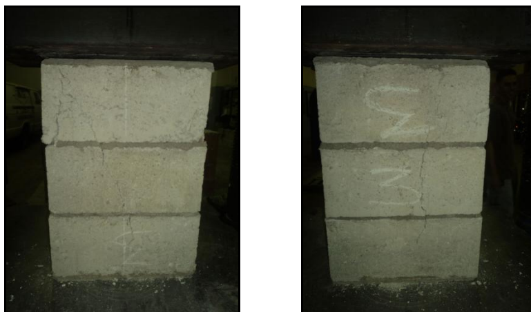
Imagen 48: Diferentes vistas de la pila 3 después del ensayo a compresión
