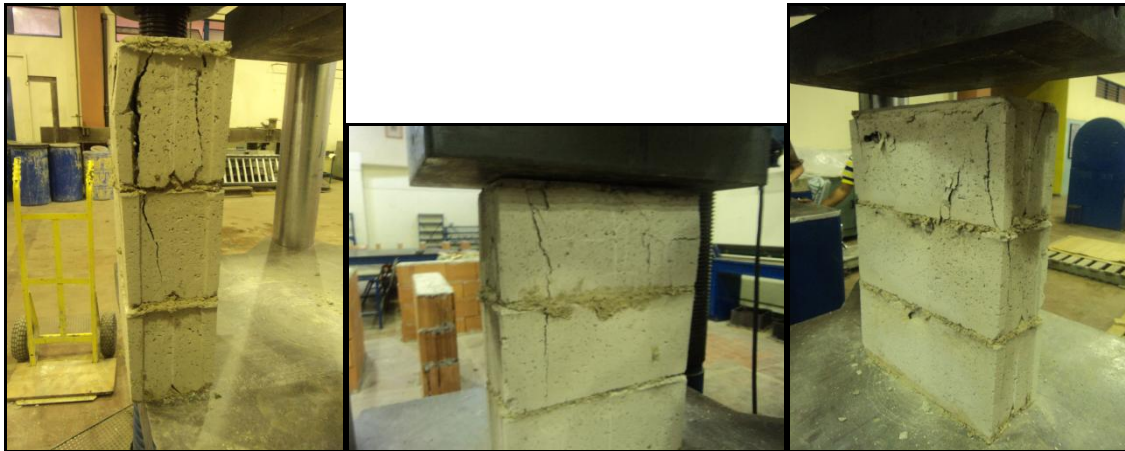
Imagen 45: Diferentes vistas de la pila P1 después del ensayo a compresión
