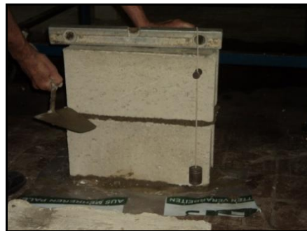
Imagen 26: Elaboración de las pilas de bloques
