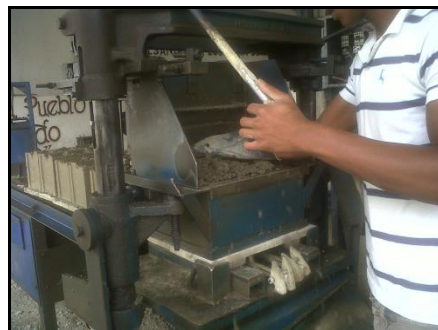
Imagen 9: Llenado del molde de la vibrocompactadora
