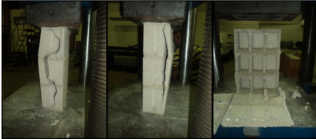
Imagen 44: Diferentes vistas de la pila 1 después del ensayo a compresión
