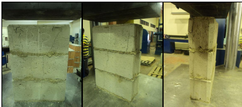
Imagen 46: Diferentes vistas de la pila P2 después del ensayo a compresión
