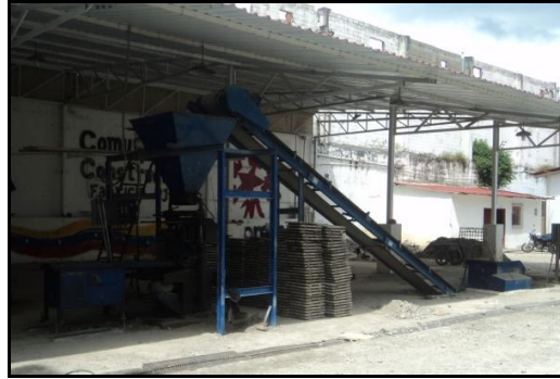
Imagen 17: Máquina vibrocompactadora Induminca
