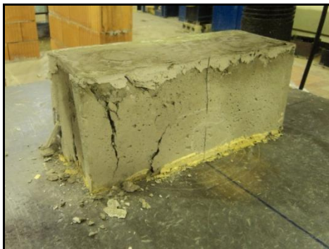
Imagen 40: Grietas perpendiculares a la carga aplicada
