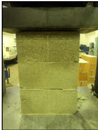
Imagen 49: Fisura paralela a la carga en el bloque superior
