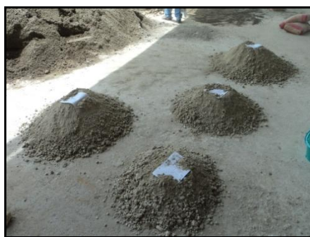
Imagen 30: Dosificación por tipo de mezcla del desecho de concreto premezclado
