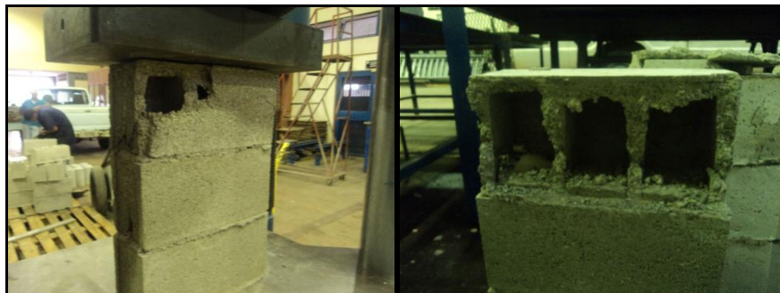
Imagen 50: Desprendimiento de la pared del bloque superior
