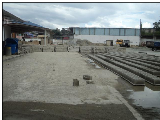
Imagen 53: Zona de curado y almacén de bloques
