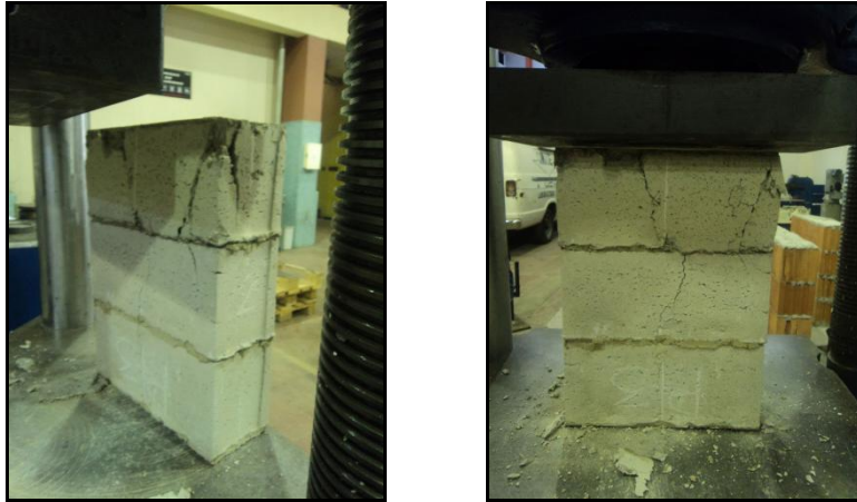
Imagen 47: Diferentes vistas de la pila P3 después del ensayo a compresión
