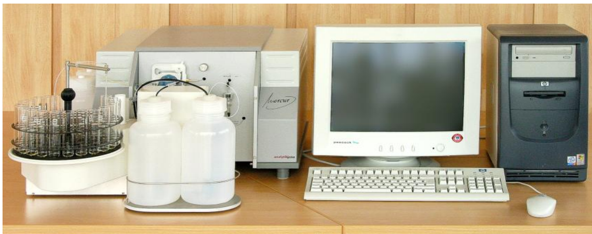
Figura 11. Espectrofotómetro de fluorescencia atómica con generación de vapor (CV-AFS), Analitikjena AG, modelo Mercur.
