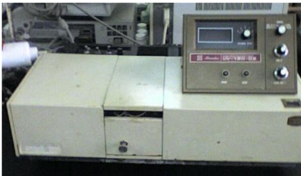
Figura 13. Espectrofotómetro de UV-visible de doble haz, marca SHIMADZU modelo UV-150-02 (UV-VIS).
