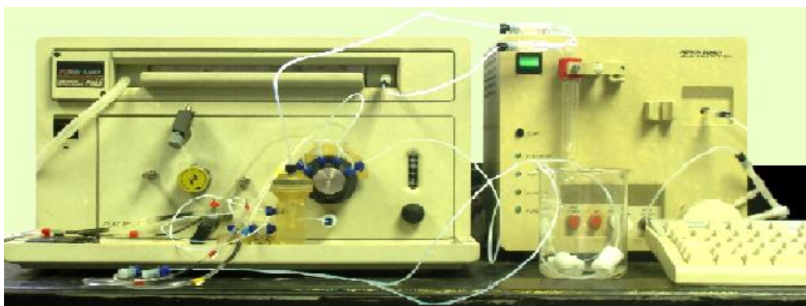
Figura 9. Espectrómetro de absorción atómica con generación de vapor, Perkin Elmer, modelo FIMS-100.
