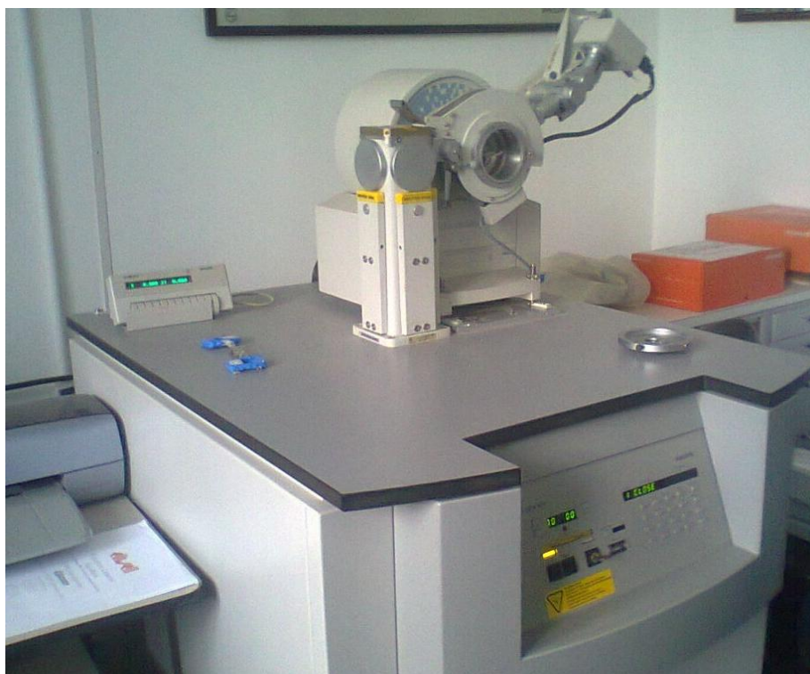
Figura 17. Equipo de difracción de rayos X utilizado para el análisis de los sedimentos Marca PW-3830.
