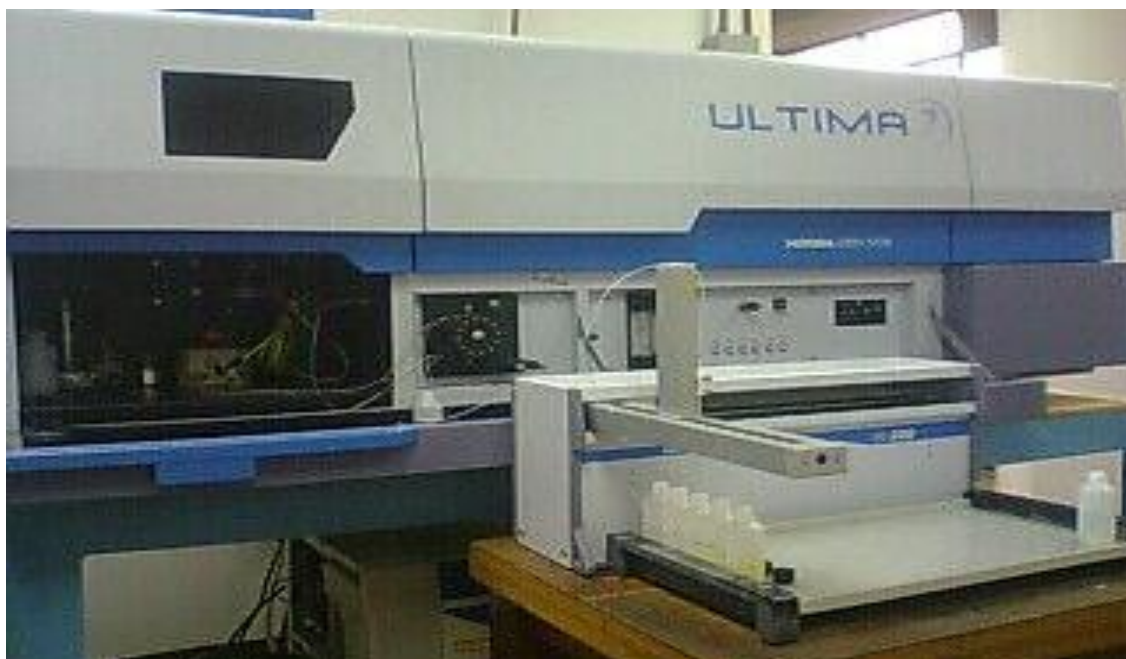
Figura 21. Equipo ICPOES utilizado para la determinación de la concentración de estroncio.
