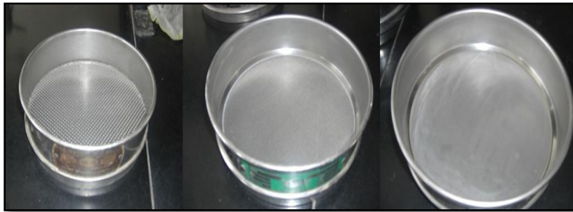
Figura 11. Tamices empleados para la separación granulométrica de las muestras de sedimentos.
