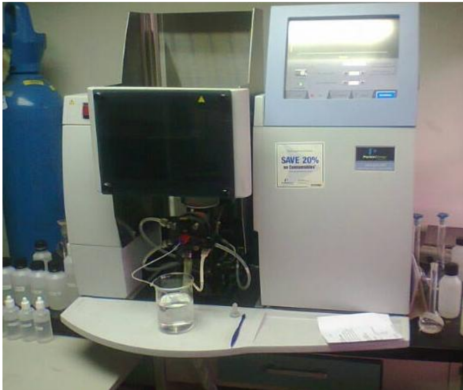
Figura 18. Equipo de absorción y emisión atómica utilizado para la determinación de la concentración de Al, Ca, Mg, Na y K.
