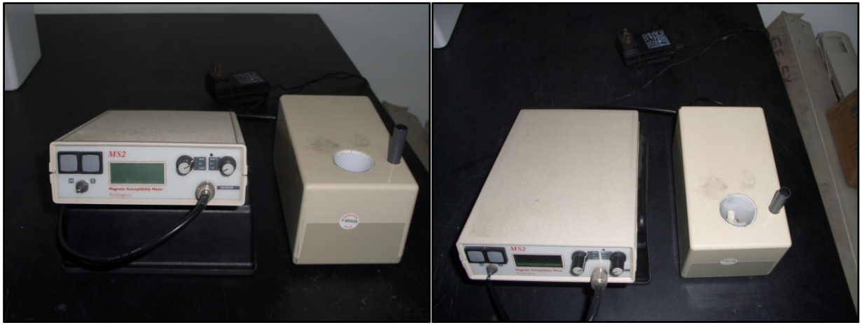
Figura 4.2. Susceptómetro MS2 (Bartington Instruments) utilizado para las mediciones de susceptibilidad magnética.
