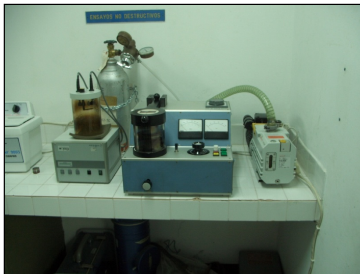
Figura 4.8. Instrumental para la aplicación del recubrimiento de oro para el análisis de microscopía electrónica y espectroscopia de rayos X. Nombre del equipo: Sputerin Hochspannung.
