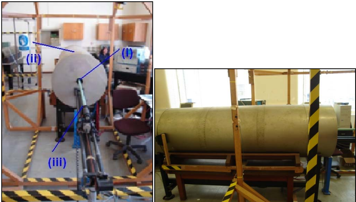
Figura 4.6. Magnetómetro. (i) Orificio para la entrada de la muestra dentro del instrumento; (ii) material aislante del campo magnético terrestre actual; (iii) mecanismo para la introducción de la muestra dentro del instrumento para su medición.
