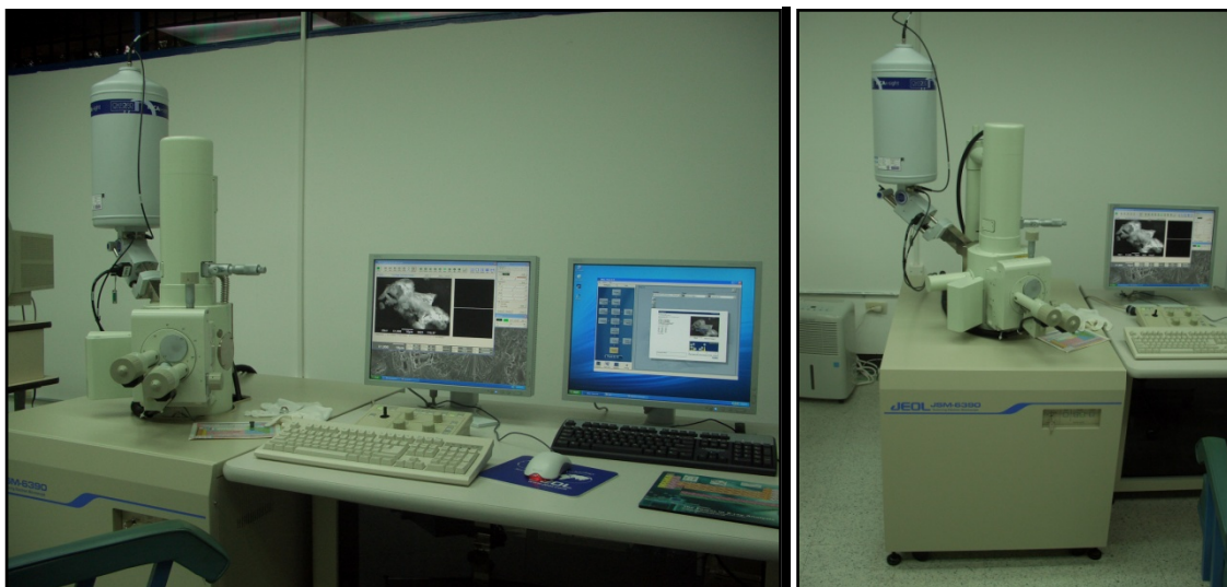
Figura 4.9. Microscopio Electrónico de Barrido JEOL JSM – 6390; y sonda de rayos X o dispersor de energía Oxford Instruments, modelo 7582.
