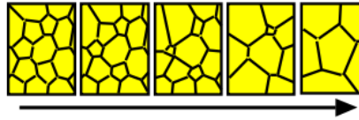
Figura 8. Aspectos de la evolución de una espuma por difusión gaseosa Intra-burbuja.
