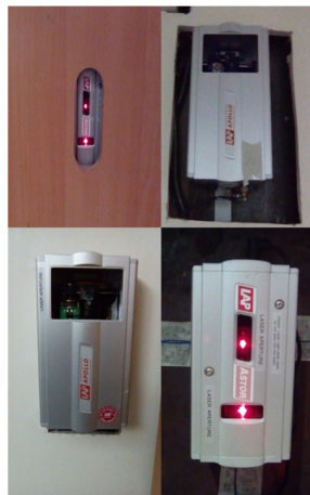
Figura 4.3: Conjunto de láseres externos marca LAP, modelo Apollo.
