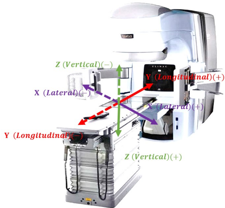
Figura 4.17: Sistema de referencia de la camilla del acelerador lineal.
