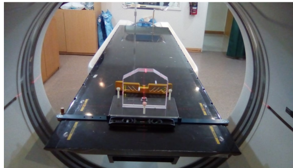
Figura 4.14: Montaje para la verificación de la alineación de los láser del gantry con el plano de exploración.
