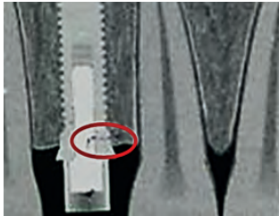
Figura 4.13 Imagen radiográfica de fractura en el cuello del implante y en el tornillo de unión.
