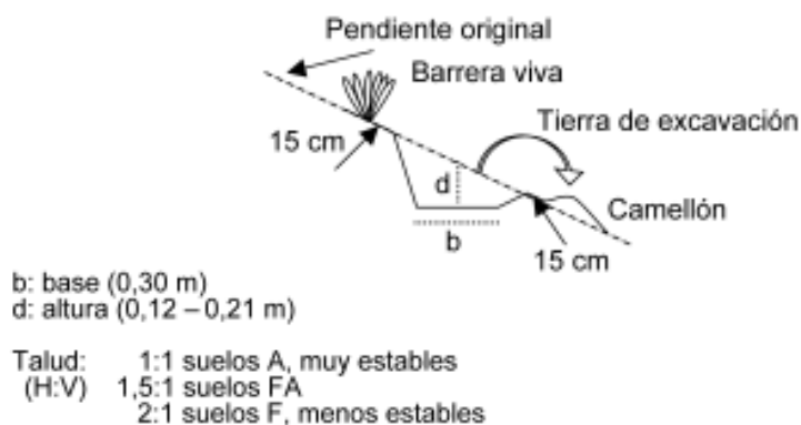
Figura V.40. Acequia o zanja de ladera (CCSA, 2005).
