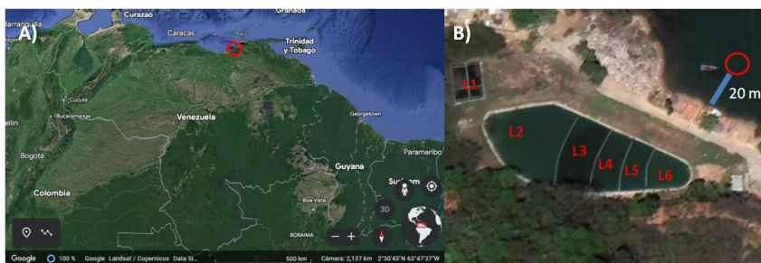
Figura 1. (A) Ubicación geográfica y (B) Vista aérea, con señalización de las lagunas y esquema del tubo de desagüe de la de la planta de tratamiento de aguas residuales de la comunidad de Mochima, edo. Sucre (Fuente Google Earth, 2023).
