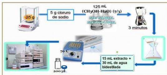
Figura 1. Método de cromatografía líquida de alta resolución (HPLC) para la cuantificación de aflatoxinas en granos de maíz.
