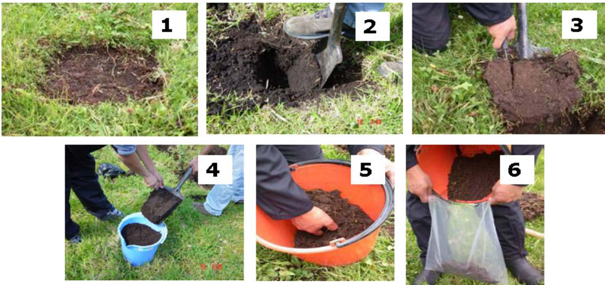
Figura 1. Procedimiento para la extracción de muestras disgregadas (Fuente: Adaptado de Cuesta y Villaneda, 2005).
