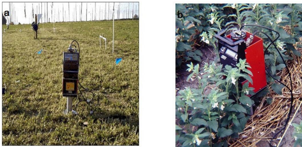
**Figura 3.** Registro del contenido de agua en el suelo en campo con sondas de neutrones, donde se observa el tubo de acceso. a) Calibrando el equipo; b) Midiendo humedad en ensayos con prácticas de conservación de suelo y agua en Turén, estado Portuguesa.
