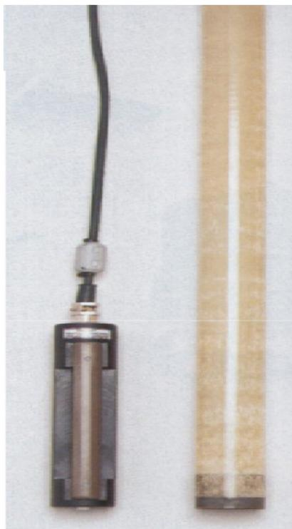
**Figura 6 .** Sonda TDR junto con el tubo para la determinación de perfiles de humedad (adaptado de Morell y Tuñón, 2003)
