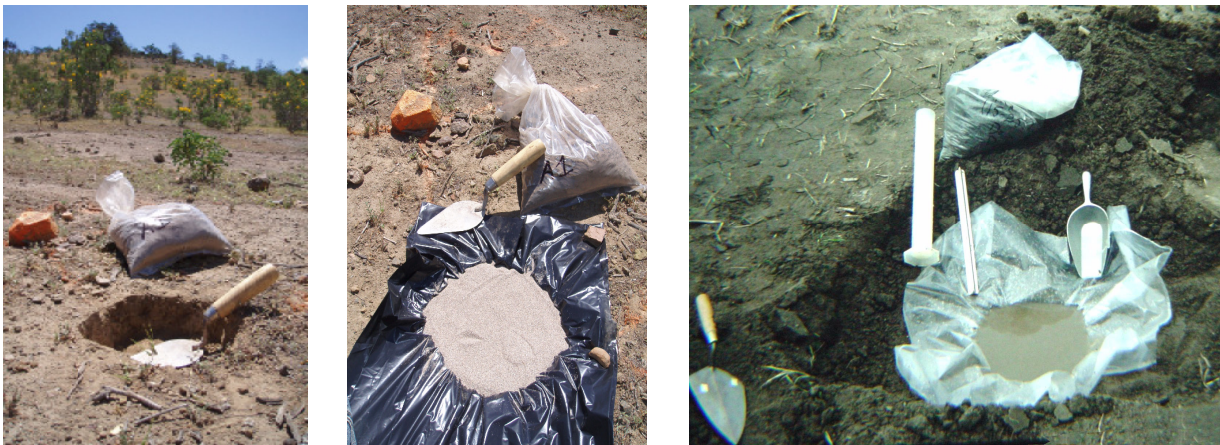
Figura 4. Determinación de la densidad aparente por el método del hoyo o excavación
