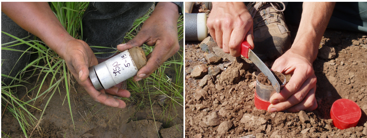
Figura 3. Toma de muestras no alteradas mediante el uso de cilindros.
