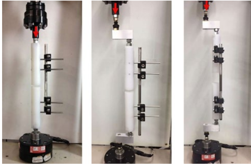
Figura 2. Imágenes de los Test F1541 de la ASTM para probar la resistencia biomecánica del montaje realizados la Universidad de Minnesota, MA, USA.
