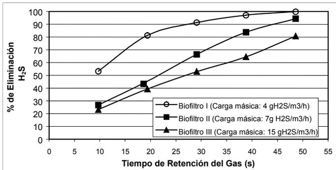
**Figura 1.** Eliminación de H<sub>2</sub>S en función del tiempo de retención para diferentes cargas máxicas en los biofiltros.
