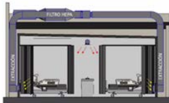
Lámina 4. Sistema de distribución de aire por desplazamiento con rejilla de extracción a la altura de la cabecera del paciente
