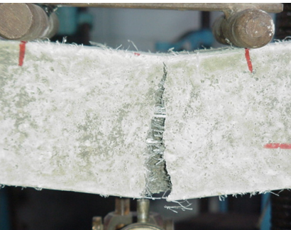
Foto 1. Ensayo de resistencia a la flexión
