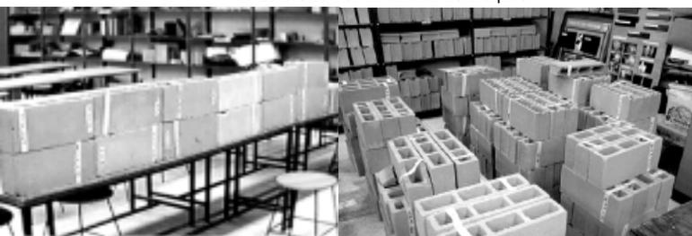
dimensiones externas (A, L, H) de los bloques. Todos están dentro de lo establecido en la norma, sobre los espesores de pared y de nervios. La norma establece 1,3 cm, cuando no son estructurales; 1,9 cm los bloques tipo A (estructurales), solamente los BHC de dos empresas están por debajo de 1.9 cm de espesor (tabla 10, gráfico 1).
