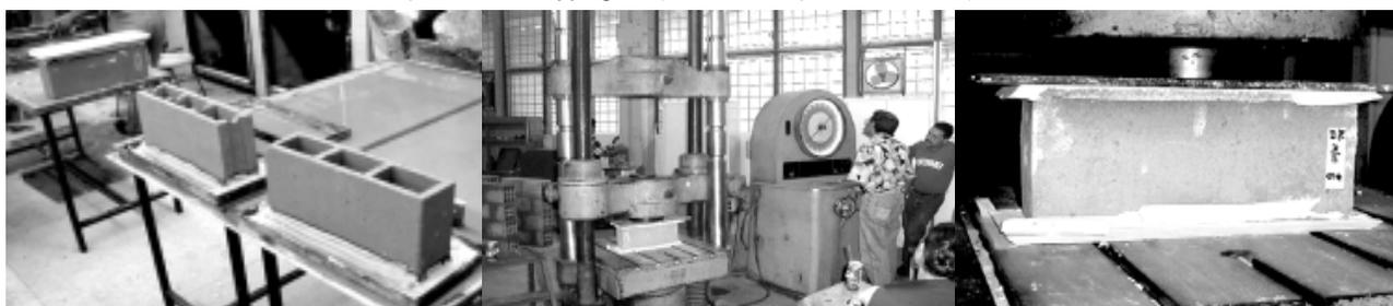
**Ensayo de absorción.** Según lo indicado en la norma, se pesó el bloque saturado a humedad ambiente, luego se sumergió en agua por un espacio de 24 horas. Se procedió en cada caso a introducir los bloques al horno y secarlos por el mismo espacio de tiempo, para luego determinar el peso seco. Se tuvo cuidado de hacer los tiempos extras de secado hasta lograr un mínimo de varianza que hiciera real la medición.
