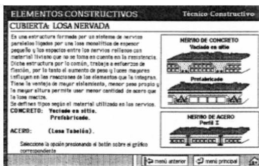
Figura 20 Tarjeta submenú «elemento constructivo»
