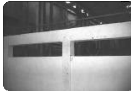
Foto 19: Modelo No. 1, escala 1 a 3, ensayado en la Universidad de los Andes
