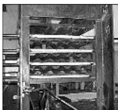
Foto 4: Prensa en frío para conformación de las tejas a partir de placas
