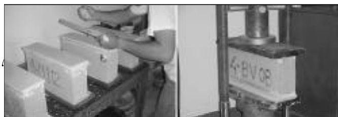
Colocación y nivelación del bloque en el camping de yeso
