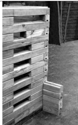
Figura 7 Utilización de madera de pino caribe de pequeños diámetros para la producción de componentes constructivos: una tecnología progresiva y sostenible. Arq. Argenis Lugo
