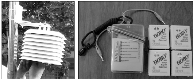
Fotos 5 y 6 Equipo de registro térmico continuo, de la familia HOBO 8
