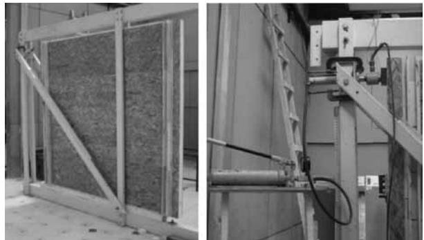
Figura 37 Muro compuesto por paneles horizontales y nodos estructurales laterales colocado en el marco rígido de prueba para ser sometido a ensayos de flexión.
