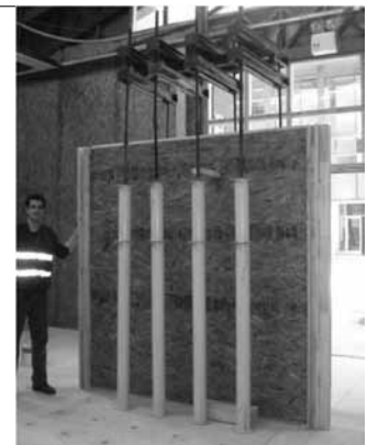
Figura 38 Muro compuesto de paneles horizontales y nodos estructurales laterales dispuesto en marco rígido de prueba para ser sometido a ensayos de compresión.
