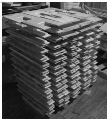
Figura 14 Fabricación seriada de Bloque base de Nodo Estructural
