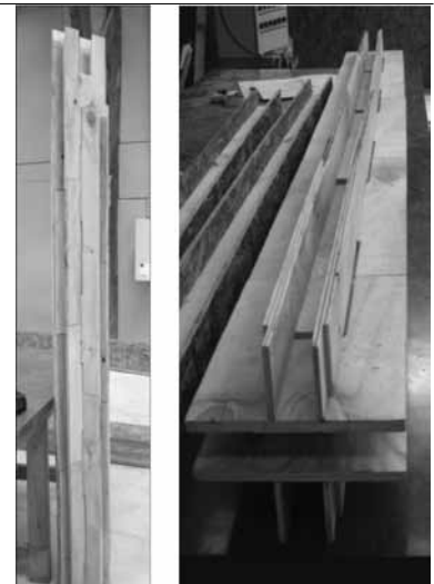
Figura 10 Pruebas de ensamble de Nodo Estructural
