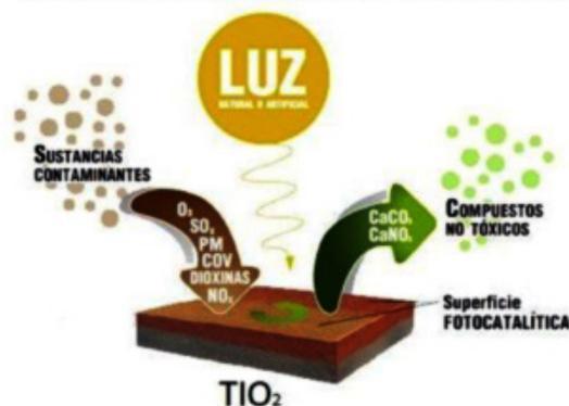
Al ser el dióxido de titanio un material fotocatalizador, degrada compuestos como dióxido de nitrógeno y dióxido de carbono entre otros contaminantes ambientales, oxidándolos gracias a la luz ultravioleta y transformándolos en sales inocuas que son fácilmente lavables de las superficies ya que incrementan la facilidad de escurrimiento del agua por añadir además hidrofiliabilidad a las mismas.
