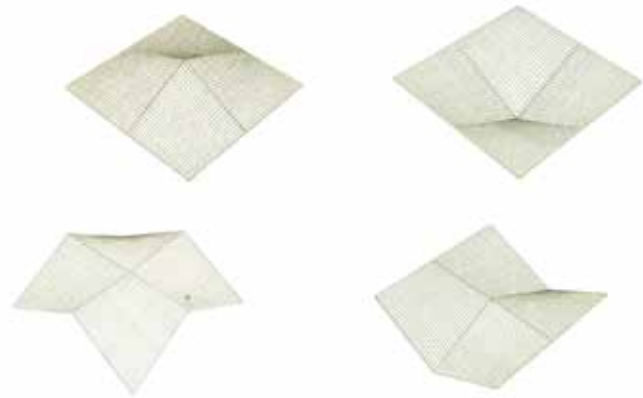
Figura 3. Paraboloides hiperbólicos de cuatro unidades configurado con el eje z en posición vertical para la modelación de cúpulas cuadrangulares
