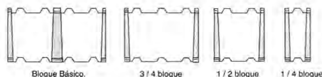
FIGURA 7 COMPONENTES PRIMARIOS DE BLOQUE PRISMÁTICO
