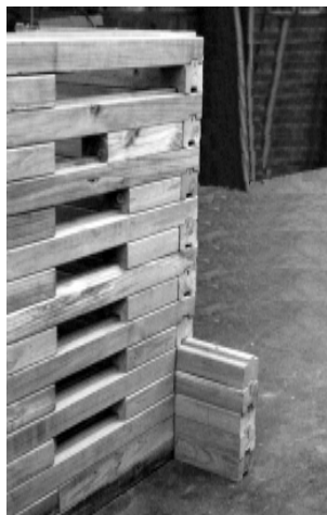
Figura 3 Modelo-prototipo de mampostería de madera
