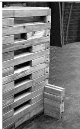
Figura 7 Utilización de madera de pino caribe de pequeños diámetros para la producción de componentes constructivos: una tecnología progresiva y sostenible. Arq. Argenis Lugo
