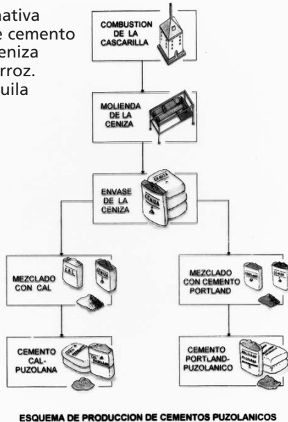
ESQUEMA DE PRODUCCION DE CEMENTOS PUZOLANICOS
